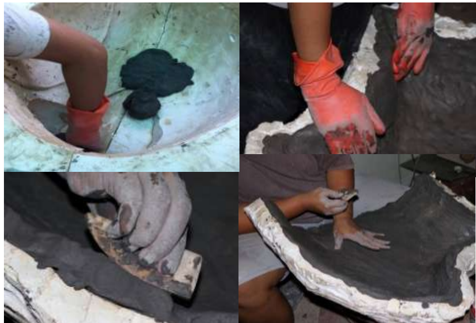
ภาพที่ 88 - 91 การนำดินเข้าอัดในพิมพ์
