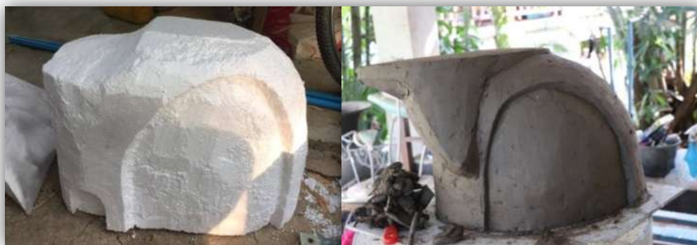
ภาพที่ 78 - 79 ภาพต้นแบบด้วยการตัดโฟมและพอกด้วยดินเหนียว
