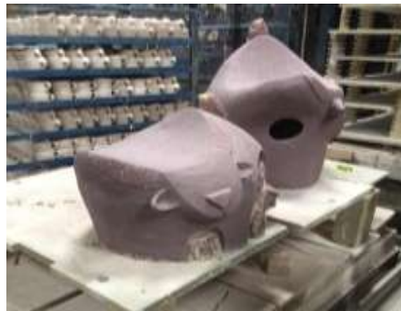
ภาพที่ 100 - 101 การเผาเคลือบอุณหภูมิ 700 องศาเซลเซียส
