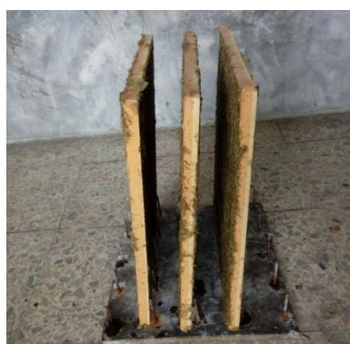
ภาพที่ 3-4 กระบวนการขึ้นรูปแผ่นฉนวนความร้อน โดยใช้วิธีพ่นเคลือบประสาน
