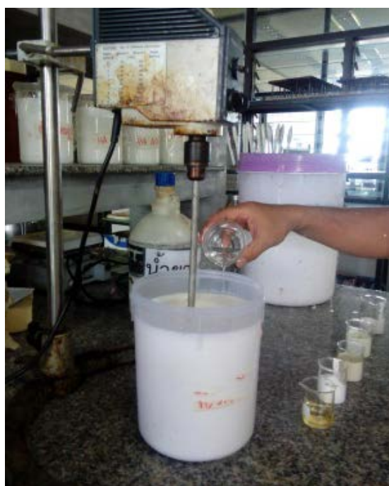
ภาพที่ 3-3 การเตรียมน้ำยางธรรมชาติสำหรับกระบวนการขึ้นรูป
