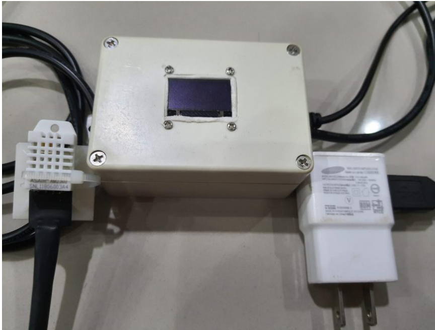
ภาพที่ 4.4 แสดง IoT Device แบบ ESP8266 12-E NodeMCU kit พร้อมอะแดปเตอร์ 5 โวลต์
