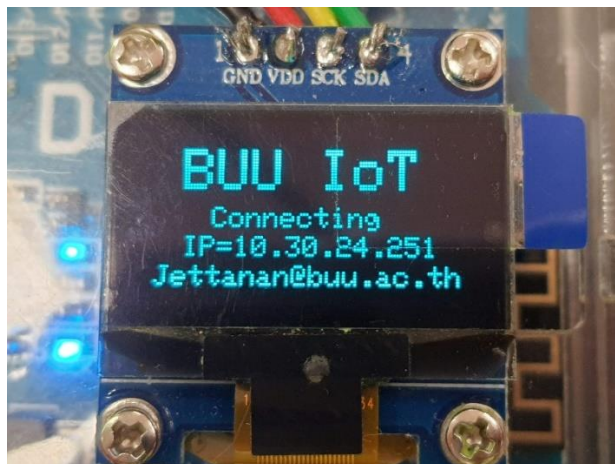
ภาพที่ 2.9 โมดูลจอแสดงผล OLED 128x64 0.96”
