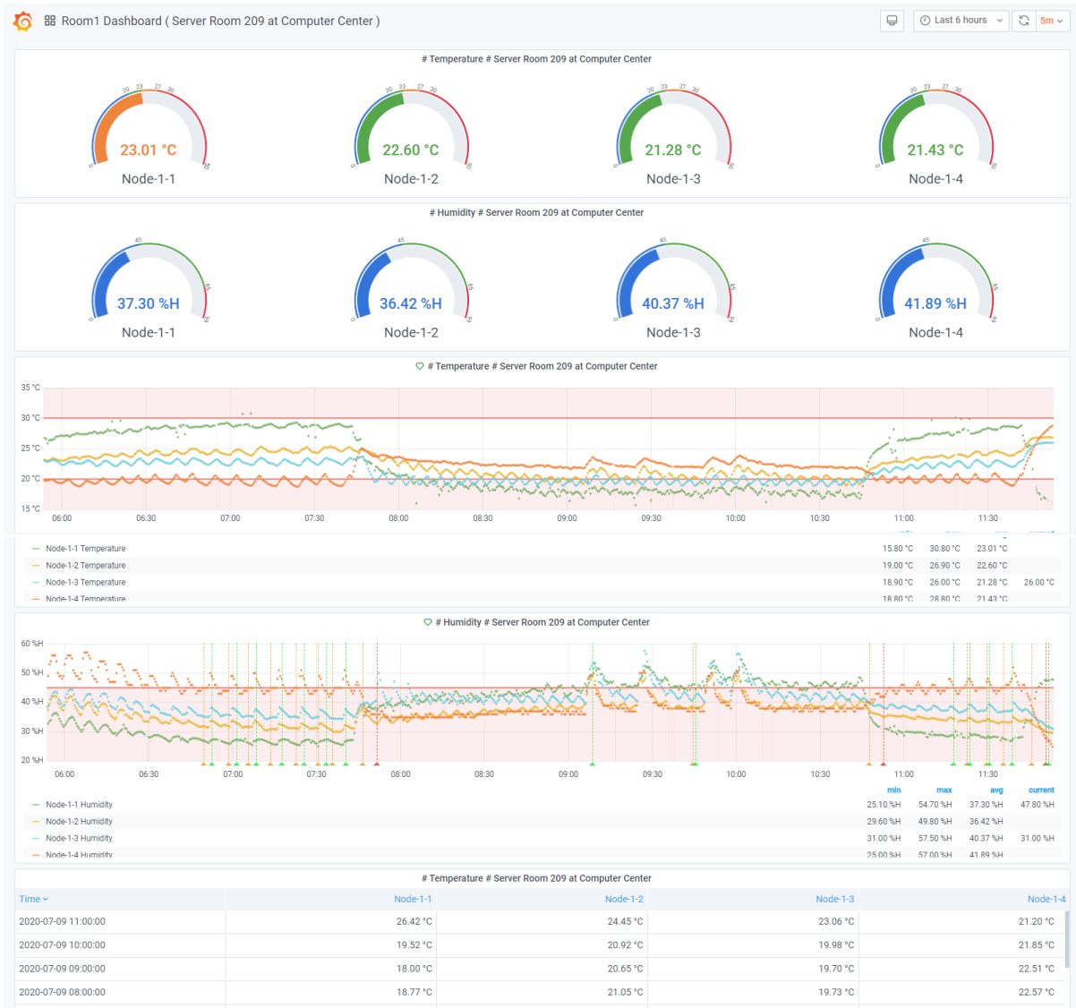
ภาพที่ 4.8 แสดงหน้ารายละเอียดของ Server Room 209 at Computer Center: http://dcr-sensor.buu.ac.th:3000/d/ofaXbGfZk/room1-dashboard-server-room-209-at-computer-center?orgId=1&refresh=5m
