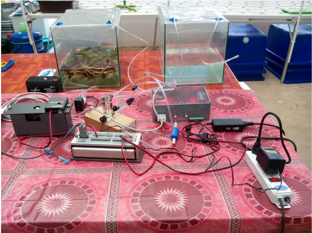
ภาพที่ 8 การติดตั้งอุปกรณ์เพื่อการศึกษาอัตราการสังเคราะห์ด้วยแสงของหญาทะเลพันธุ์ E. acoroides Linn. ใน ระบบปิด
