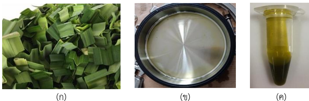
รูปที่ 4.15 แสดงภาพใบเตยก่อนทำการสกัด (ก) น้ำมันใบเตยหลังการสกัด (ข) และ (ค) โดยเทคนิคการสกัดด้วยบิวเทนภายใต้แรงดันสูง
