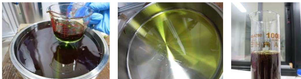
รูปที่ 4.14 สารสกัดหยาบจากตะไคร้สดปั่นละเอียดร่วมกับน้ำมันพีช (อัตราส่วน 1:1) โดยการสกัดด้วยบิวเทน ภายใต้อุณหภูมิสูง
