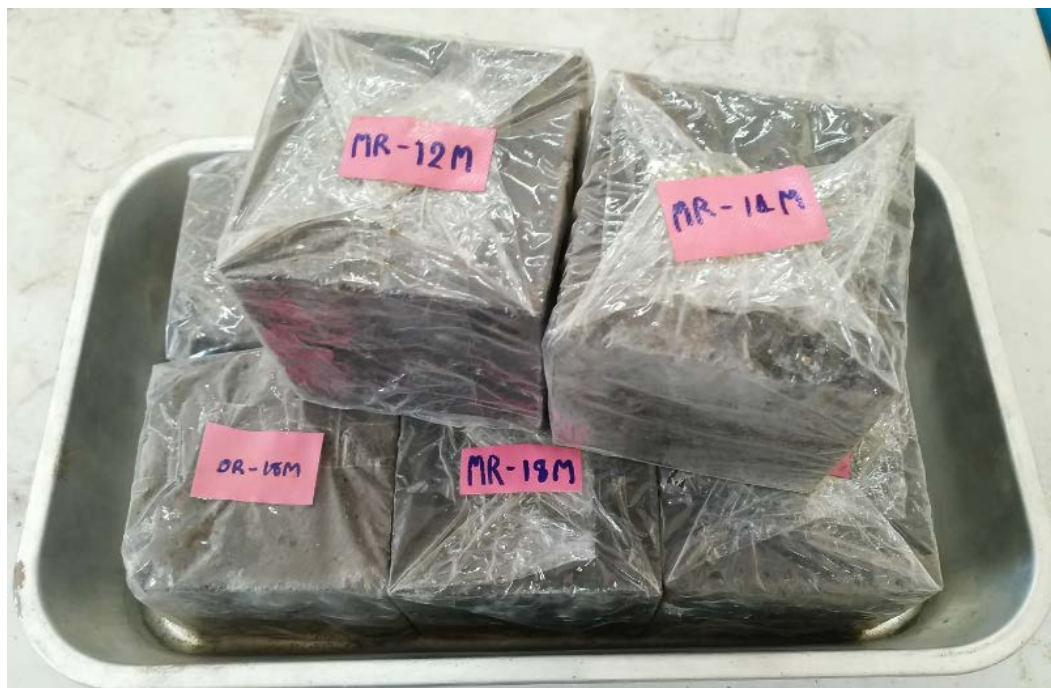
รูปที่ 3.8 จีโอฟิลิเมอร์คอนกรีตแข็งตัวที่บ่มในอากาศ
