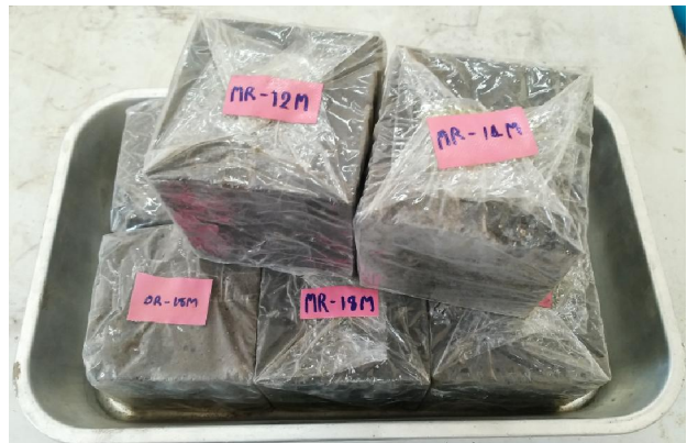
รูปที่ 2 จีโอพอลิเมอร์คอนกรีตแข็งตัวที่บ่มในอากาศ
