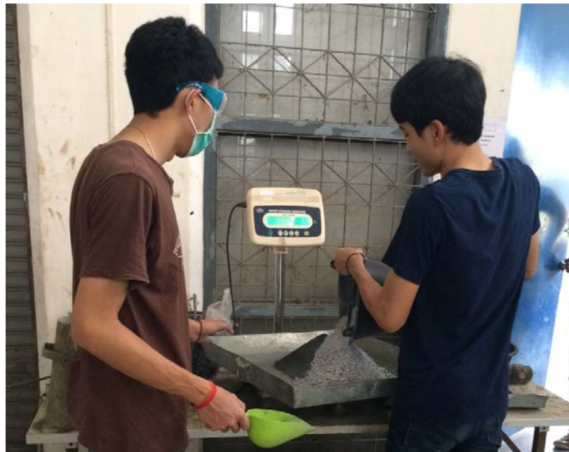
รูปที่ 3.13 การชั่งวัสดุคอนกรีตบล็อกเพื่อเข้าเครื่องอัด
