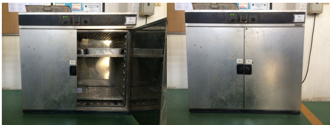
รูปที่ 3.6 ตู้อบคอนกรีตบล็อก
