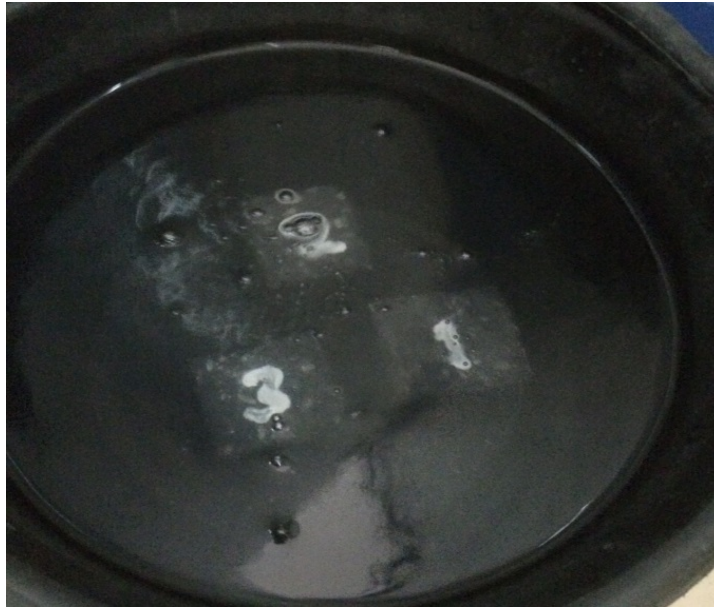
รูปที่ 3.23 การนำคอนกรีตบล็อกไปแช่น้ำ
