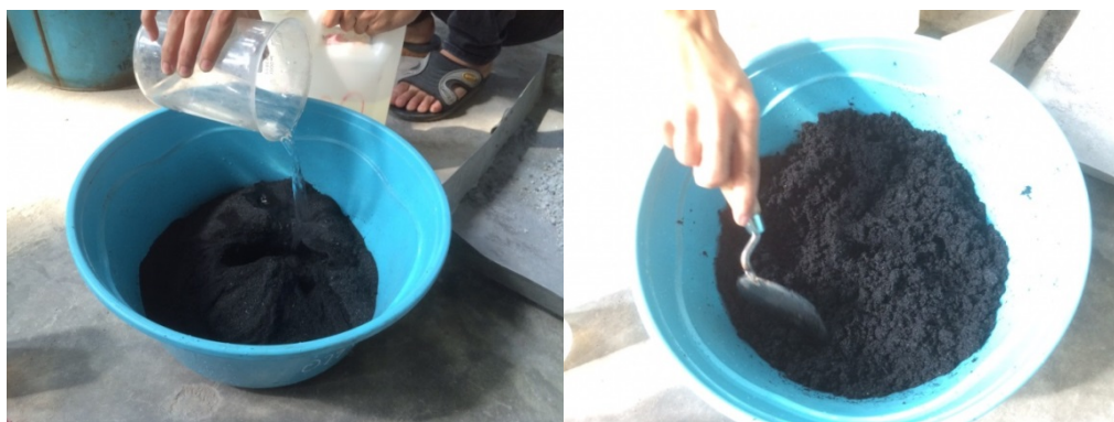
รูปที่ 3.11 การผสมเถ้าแกลบและสารละลาย NaOH
