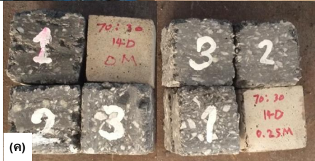
รูปที่ 1 (ก) อัดคอนกรีตบล็อกด้วยเครื่องอัดชนิดซินวาแรม (ข) บ่มคอนกรีตบล็อกในอากาศที่อุณหภูมิห้อง (ค) ตัวอย่างคอนกรีตบล็อกขนาด 50 \times 50 \times 50 มม.
