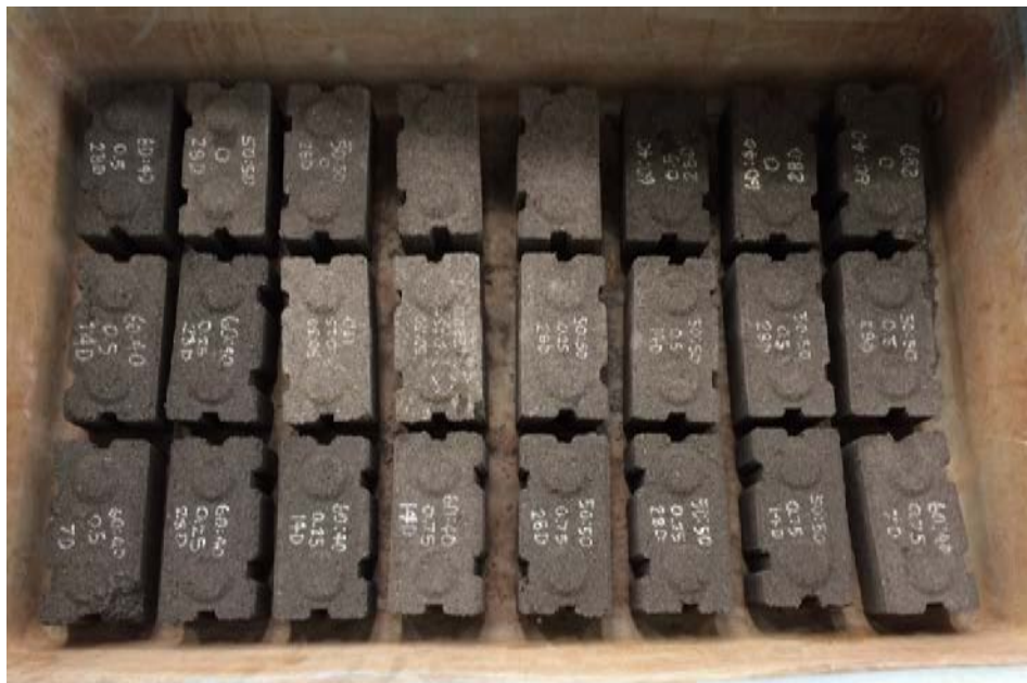
รูปที่ 3.17 การบ่มคอนกรีตบล็อก
