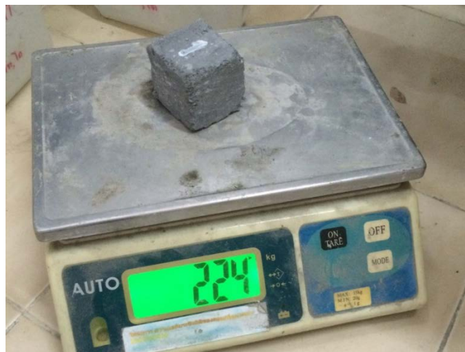
รูปที่ 3.21 การชั่งน้ำหนักตัวอย่างคอนกรีตบดอัด
