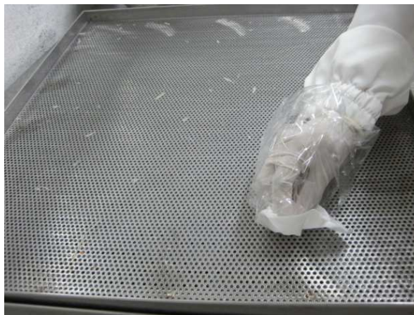
รูปที่ 3.6 การใช้ swab : โดยการใช้วัสดุกวาดผิวหน้าของภาชนะขนาด 900 ตารางเซนติเมตร
