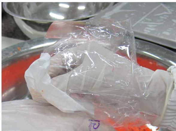
รูปที่ 3.5 วิธีการใช้วิธี swab โดยเปิดปากถุงแล้วใช้มือดันวัสดุสำหรับกวาดผิวหน้าตัวอย่างจากด้านล่างถุง ดันขึ้นไปทางด้านบน
