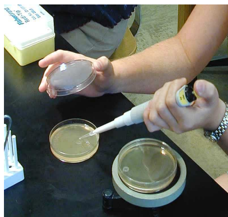
รูปที่ 2.11 วิธีการ drop plate
