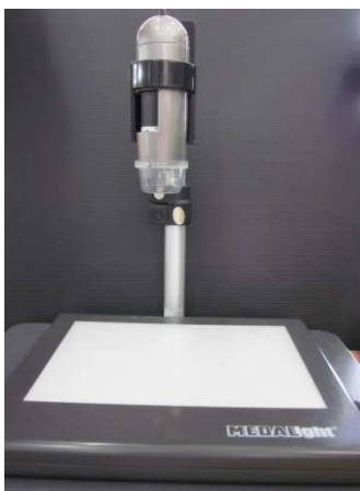
รูปที่ 3.1 กล้องดิจิทัลกำลังขยายสูงเพื่อการตรวจ detect การปนเปื้อนของ E. coli /coliform
