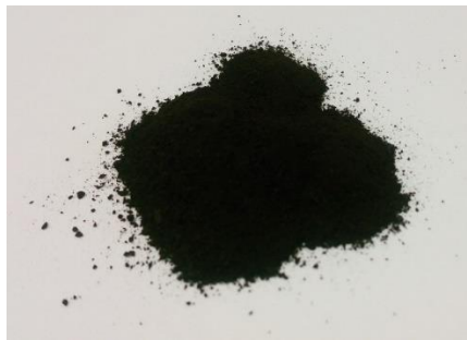
รูปที่ 3.1 อนุภาคนาโนเหล็กออกไซด์ที่สังเคราะห์ได้
