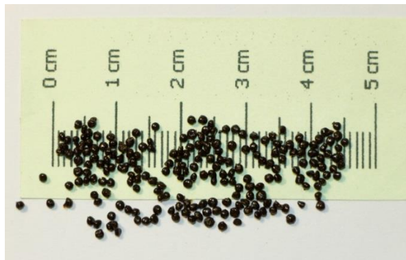
รูปที่ 3.8 เม็ดพอลิเมอร์ผสมไคโตซาน/อนุภาคนาโนเหล็กออกไซด์ /เจลาตินที่มีการเชื่อมโยงระหว่างโมเลกุลด้วยกลูตารัลดีไฮด์
