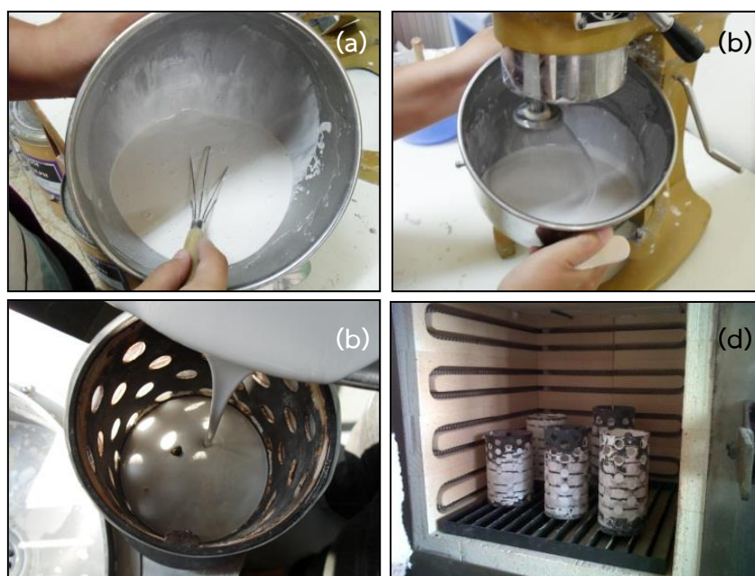
ภาพที่ 3.13 ขั้นตอนการเตรียมปูน (a) การคนปูนด้วยมือ (b) การผสมปูนด้วยเครื่องคนปูน (c) การเทปูนลงในเบ้าโลหะ และ (d) เบ้าโลหะในเตาไฟฟ้า
