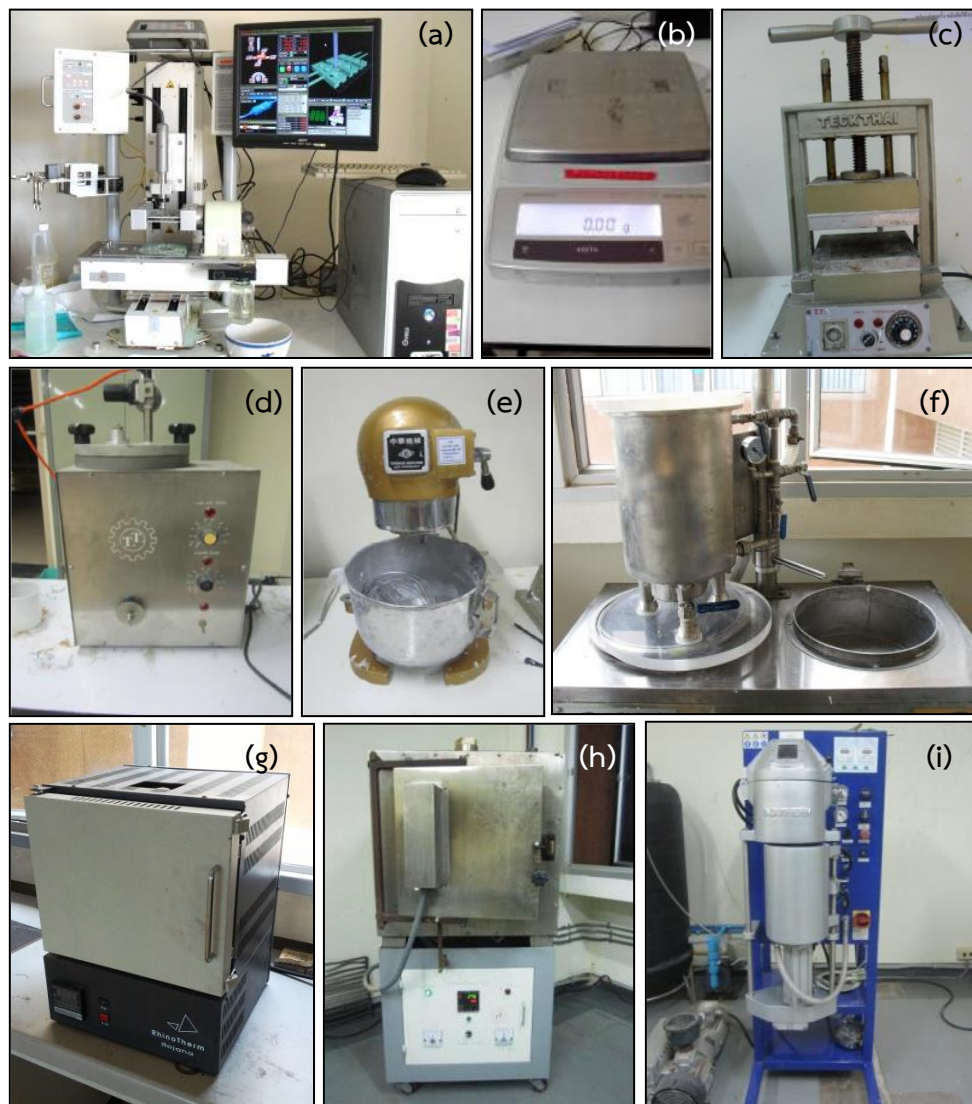
ภาพที่ 3.7 เครื่องมือที่ใช้ในการทดลอง (a) เครื่อง CNC (b) เครื่องชั่งน้ำหนัก (c) เครื่องอัดพิมพ์ยาง (d) เครื่องฉีดเทียน (e) เครื่องผสมปูน (f) เครื่องดูดอากาศ (g) เตาอบไฟฟ้า (h) เตาไฟฟ้าอบเบ้าปูน และ (i) เครื่องหล่อโลหะไฟฟ้าแบบขดลวดเหนี่ยวนำ
