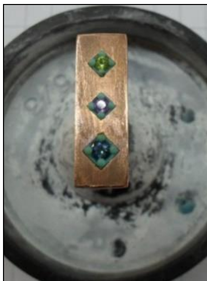
ภาพที่ 3.16 การฝังพลอยเพื่อเตรียมการหล่อ
