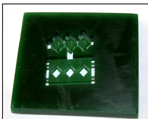
ภาพที่3.10 ลักษณะชิ้นงานทดสอบหลังการแกะเว็ทซ์
