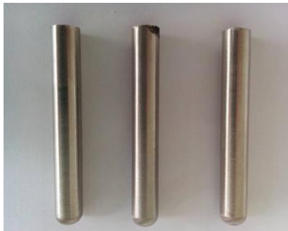
รูปที่ 2.2 แท่งแม่พิมพ์สแตนเลสสำหรับเตรียมแคปซูลเบอร์ศูนย์
