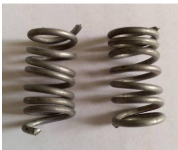
รูปที่ 2.4 ขดลวดสำหรับกดปลอกแคปซูลให้จมน้ำขณะทดสอบ
