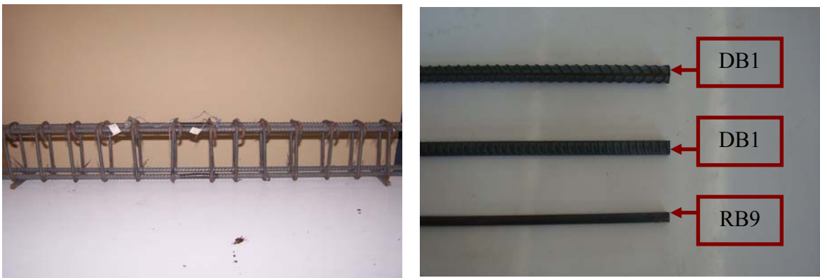
รูปที่ 3.9 เหล็กเสริมที่ใช้ในการหล่อตัวอย่างคาน ค.ส.ล.
