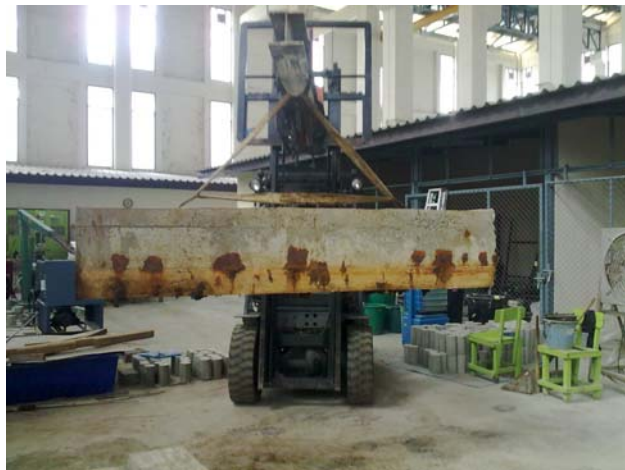
รูปที่ 4.1 การเร่งปฏิกิริยาสนิมคาน ค.ส.ล.ในบ่อ และเครื่องควบคุมกระแสไฟฟ้าคงที่
