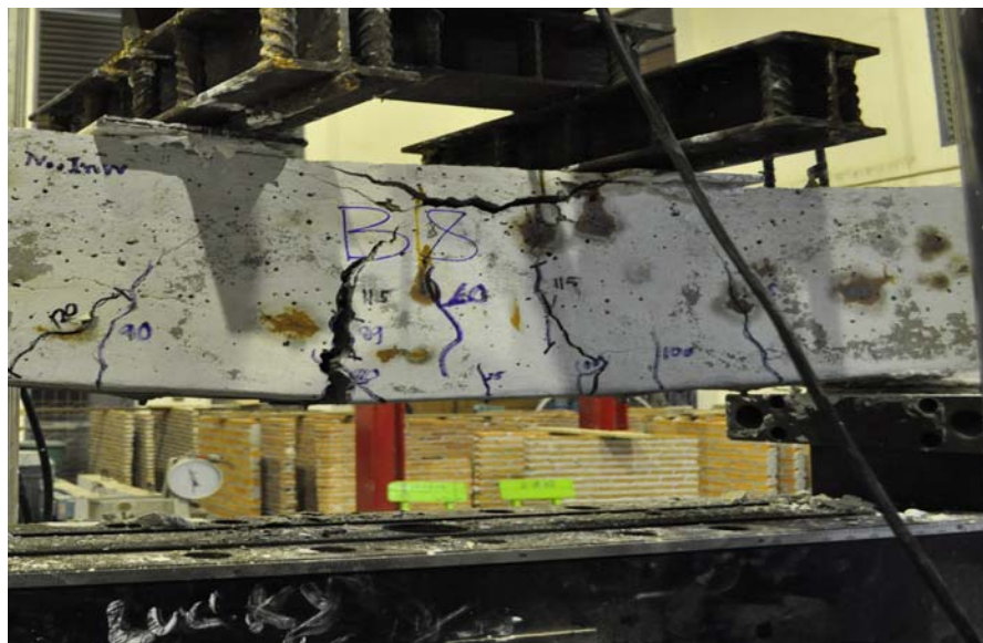
รูปที่ 5.4 ลักษณะการวิบัติของคาน B1, B1E15, B1E50
