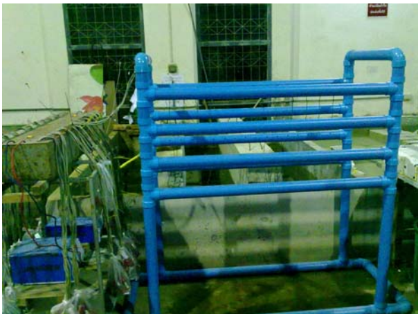
รูปที่ 4.1 การเร่งปฏิกิริยาสนิมคาน ค.ส.ล.ในบ่อ และเครื่องควบคุมกระแสไฟฟ้าคงที่
