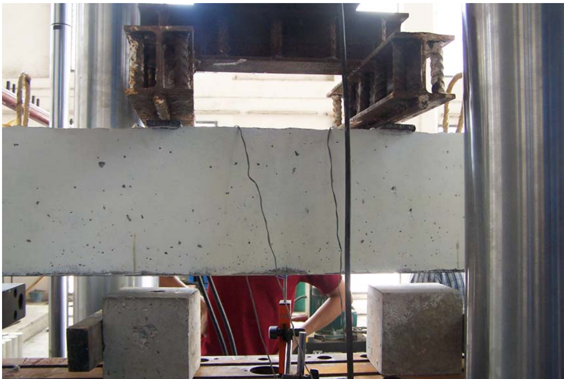
รูปที่ 5.2 การติดตั้งอุปกรณ์และการทดสอบคาน ค.ส.ล.
