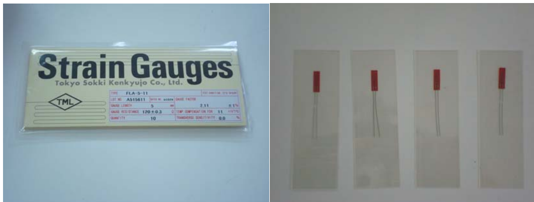
รูปที่ 3.3 อุปกรณ์วัดการยืดตัวของวัสดุที่ใช้ในการทดลอง
