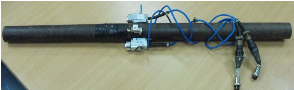
รูปที่ 3-1 ชุดเครื่องมือวัดพลังงาน ตามมาตรฐานการทดสอบ ASTM D4633 (2005)
