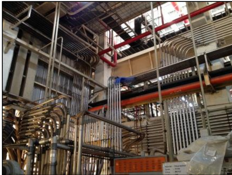
ภาพที่ 4-12 บริเวณท่อลำเลียงจากเครื่องอบเข้าเครื่องฉีด
