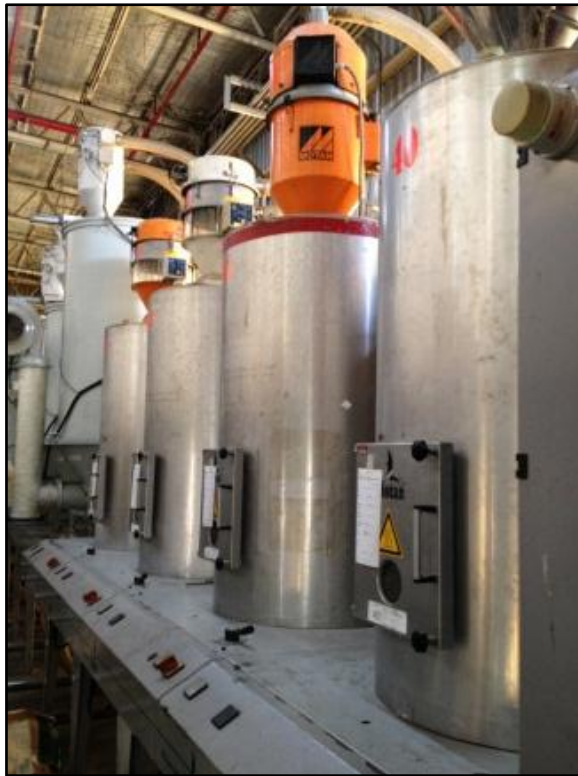
ภาพที่ 4-10 ถังอบเม็ดพลาสติก (Hopper)
