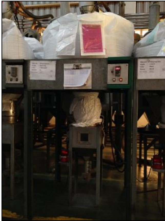
ภาพที่ 4-9 Stand สำหรับ Load เม็ดพลาสติกเข้าสู่ถังอบ
