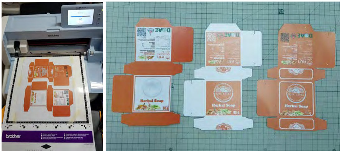
ภาพที่ 3-35 ตัด Mockup ต้นแบบบรรจุภัณฑ์สบู่สมุนไพรตะไคร้ ข่า ขมิ้น ที่มา: มียอง ขอ
