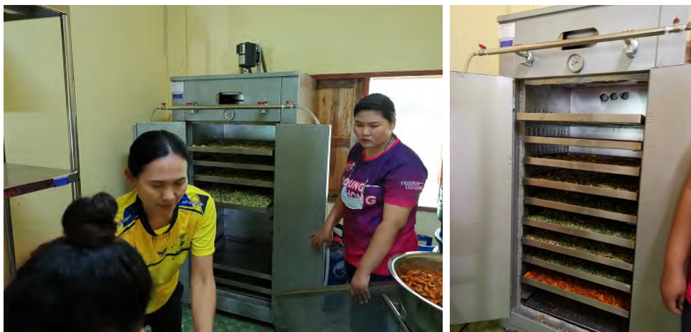
ภาพที่ 4-9 นำสมุนไพรอบแห้งที่ตู้อบลมร้อน ใช้เชื้อเพลิงแก๊ส LPG ที่มา: มียอง ซอ
