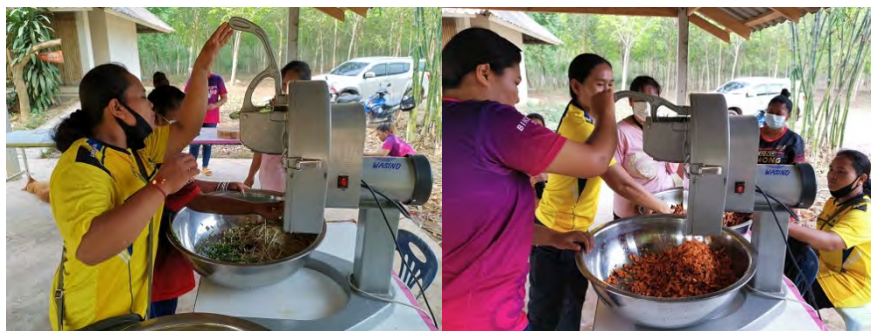
ภาพที่ 4-7 หั่นซอยสมุนไพรให้มีขนาดเล็ก ด้วยเครื่องหั่น ซอย ที่มา: มียอง ซอ
