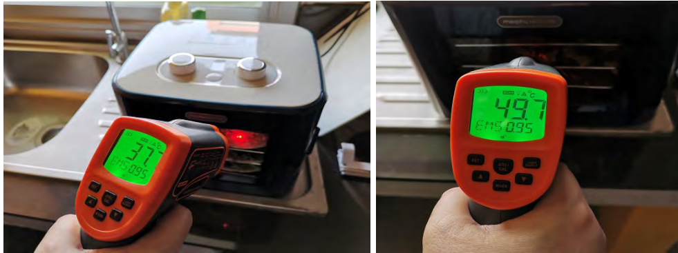
ภาพที่ 3-16 ตรวจสอบอุณหภูมิที่ใช้อบ
