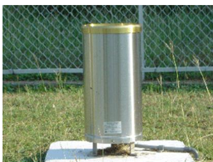
ภาพที่ 2-12 เครื่องมือวัดปริมาณน้ำฝนแบบบันทึกแบบคานกระดก
