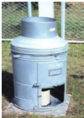
ภาพที่ 2-11 เครื่องมือวัดปริมาณน้ำฝนแบบบันทึกแบบตาชั่งวัดน้ำหนัก
