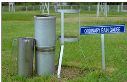
ภาพที่ 2-9 เครื่องมือวัดปริมาณน้ำฝนแบบมาตรฐาน
