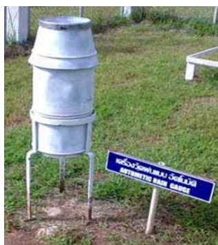
ภาพที่ 2-10 เครื่องมือวัดปริมาณน้ำฝนแบบบันทึกแบบกาลักน้ำ
