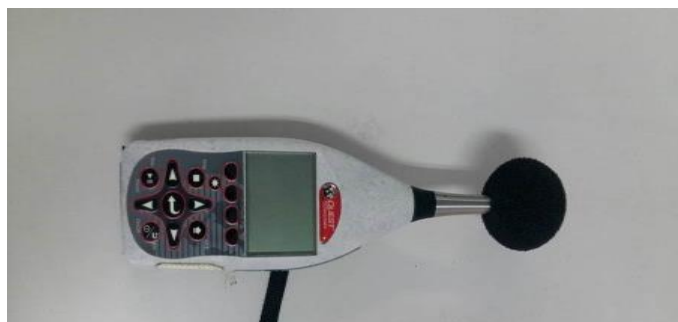
ภาพที่ 4 เครื่องวัดระดับความดังของเสียง (Sound level meter)
