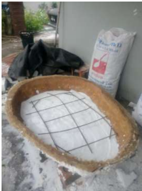
ภาพที่ 3-66 ทาน้ำมันพืชผสมน้ำยาล้างจานที่พิมพ์ยางพาราจากนั้นจึงเทปูนพลาสติกและนำเหล็กเส้นวาง เพื่อให้ชิ้นงานมีความแข็งแรง
