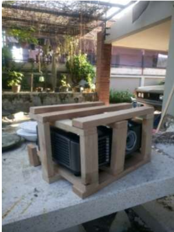
ภาพที่ 3-91 ขั้นตอนการทำที่ยึดเครื่องโปรเจคเตอร์
