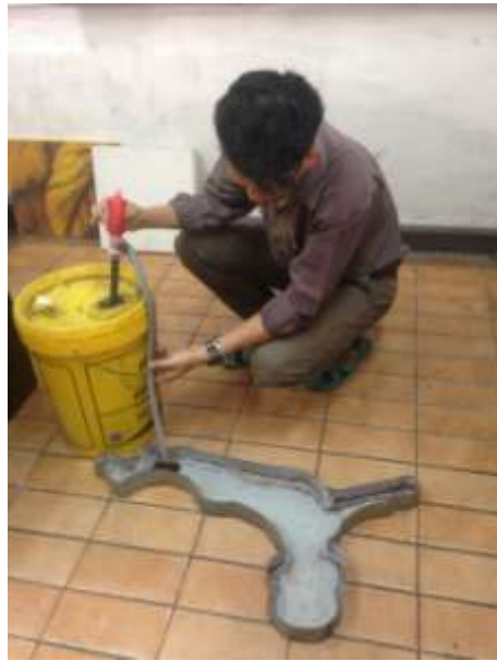
ภาพที่ 3-16 ขั้นตอนการเทน้ำมันเครื่องลงชิ้นงานจริง
