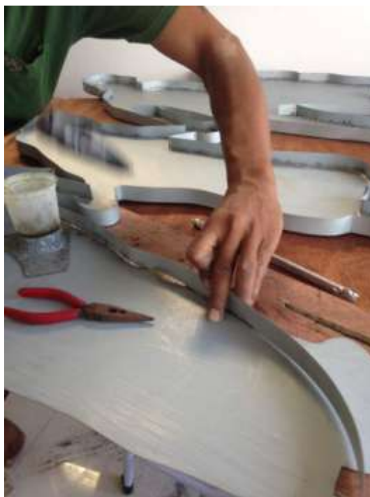
ภาพที่ 3-25 จากนั้นส่งแบบให้กับทางร้านเพื่อตัดแผ่นเหล็กซิงค์ให้ได้ตามแบบ และแผ่นเหล็กซิงค์ที่เป็นเส้นแบบยาวขนาดเส้นละ 1 นิ้ว ใช้ในการยกขอบผลงาน
