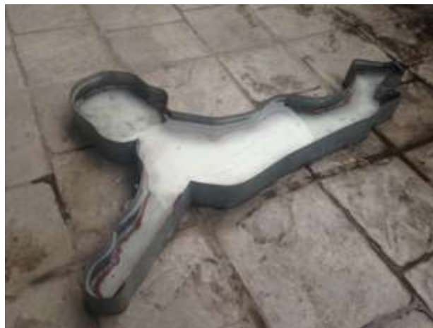
ภาพที่ 3-15 ขั้นตอนการใส่น้ำเพื่อตรวจหารอยรั่วซึมของตัวชิ้นงาน(ด้านข้าง)
