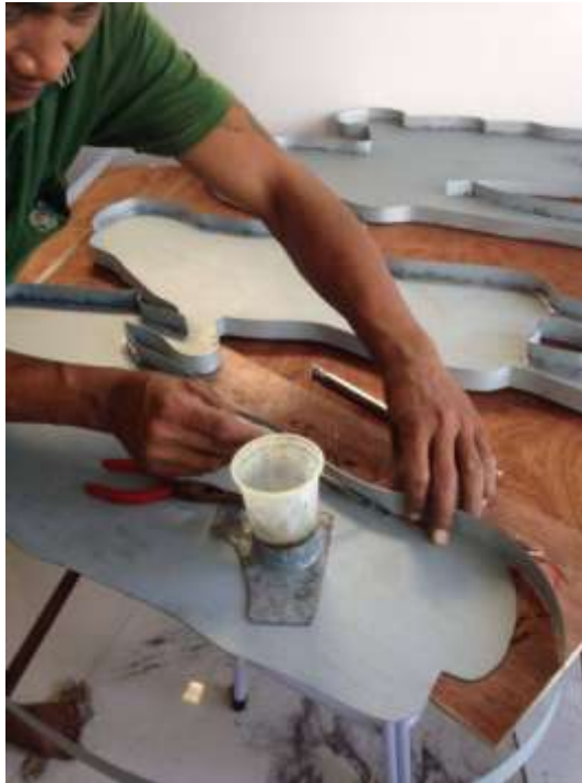
ภาพที่ 3-26 ช่างได้หยอดน้ำกรดลงไปเพื่อให้ซึมลงไปในช่องว่างระหว่างแผ่นเหล็กซิงค์
