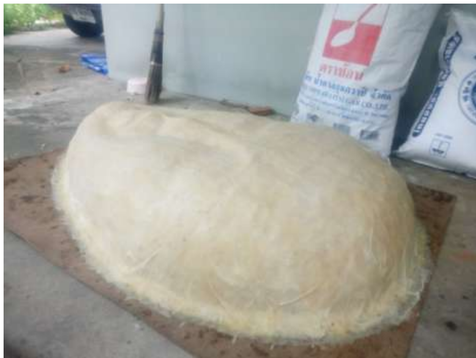
ภาพที่ 3-61 จนครบจำนวน10ชั้นเป็นอันเสร็จสมบูรณ์ขั้นตอนการทำพิมพ์ยางพารา
