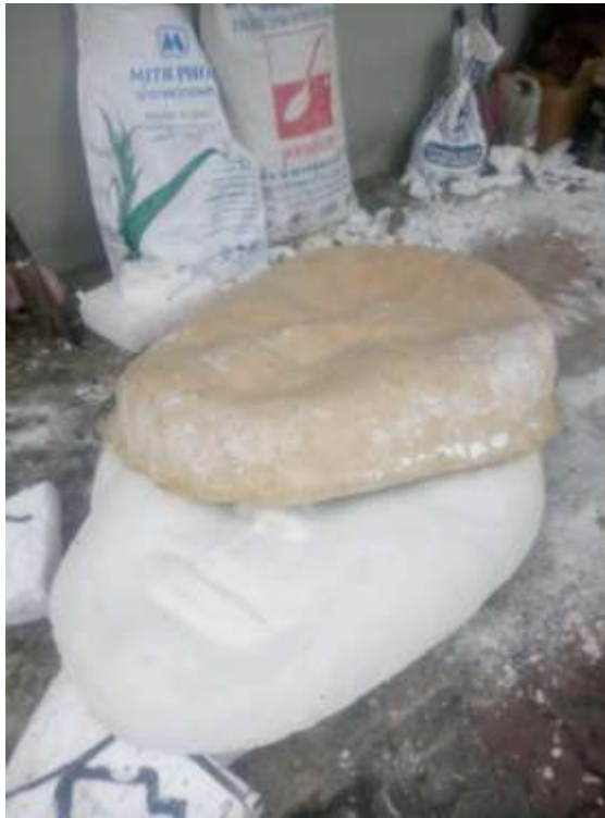
ภาพที่ 3-68 ถอดชิ้นงานปูนปลาสเตอร์ออกจากพิมพ์ยางพารา
