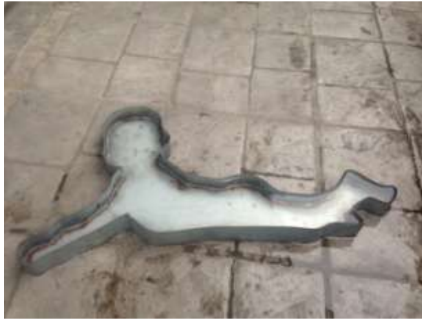
ภาพที่ 3-14 ขั้นตอนการใส่น้ำเพื่อตรวจหารอยรั่วซึมของตัวชิ้นงาน
