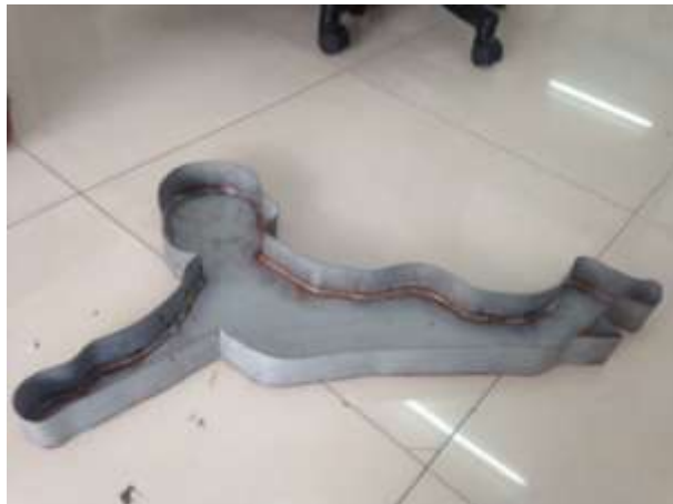
ภาพที่ 3-13 นำต้นแบบส่งให้กับทางร้านเพื่อทำในส่วนของขั้นตอนการตัดแผ่นเหล็กซิงค์และยกขอบด้านข้าง
