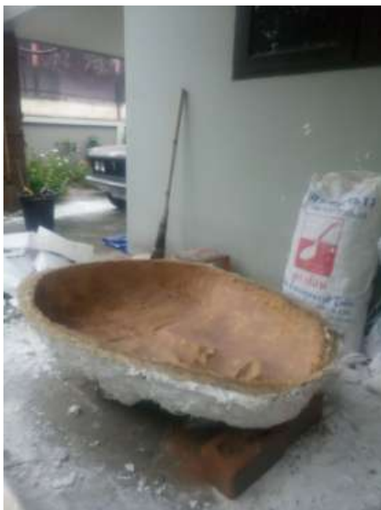
ภาพที่ 3-65 นำโครงสร้างภายในออกให้เหลือแต่ชั้นที่เป็นพิมพ์ยางพารา
