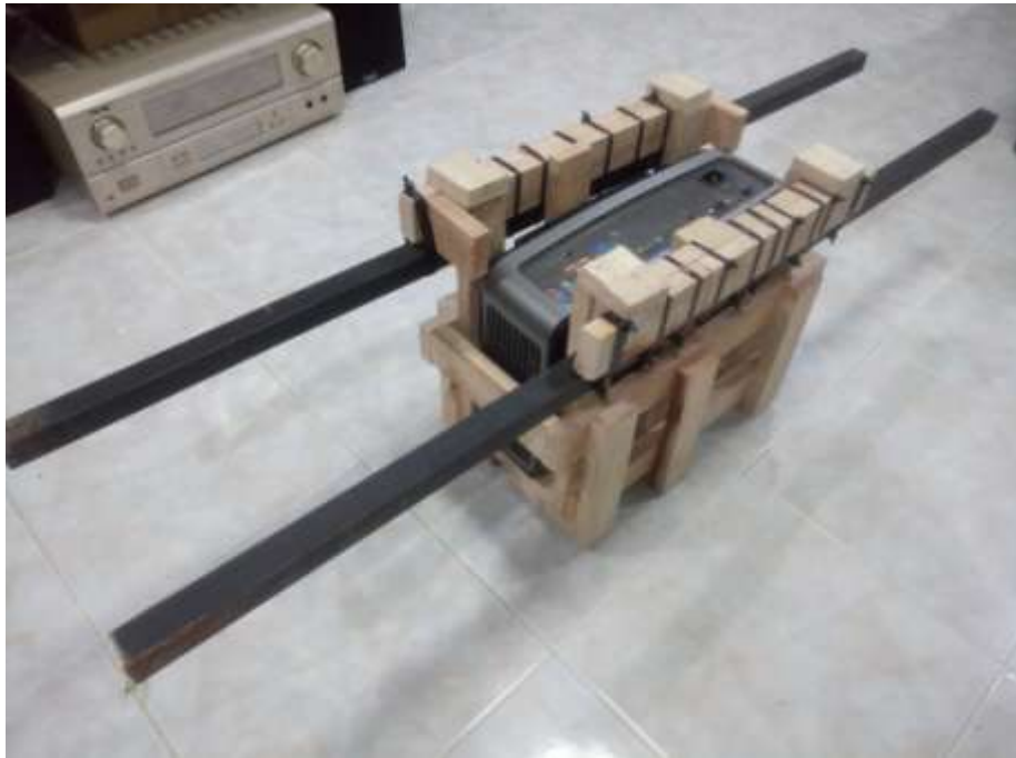
ภาพที่ 3-93 นำที่ยึดเครื่องโปรเจคเตอร์ผูกติดกับแท่งเหล็กไว้เพื่อเสริมความแข็งแรงตอนยึดติดกับคาน
