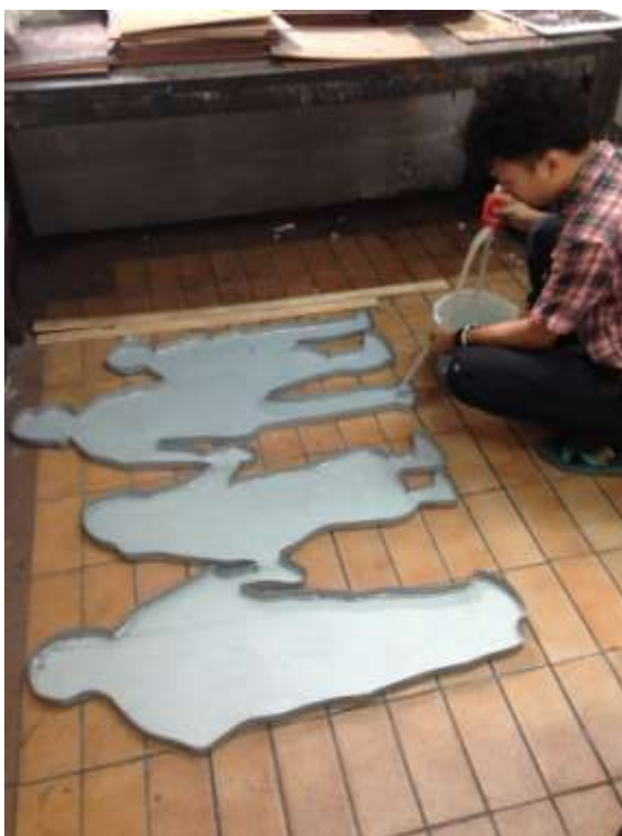
ภาพที่ 3-31 ผลงานเมื่อเชื่อมแผ่นเหล็กซิงค์จนเสร็จสมบูรณ์ จากนั้นผู้วิจัยได้ทดลองใส่น้ำ เพื่อตรวจสอบรอยร้าวของผลงาน
