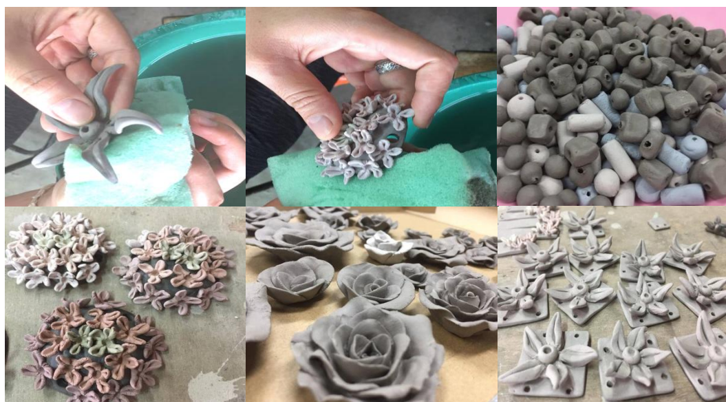
ภาพที่ 3.16 ชิ้นงานฝังแห้งและตกแต่งด้วยฟองน้ำชุบน้ำบิดหมาด
