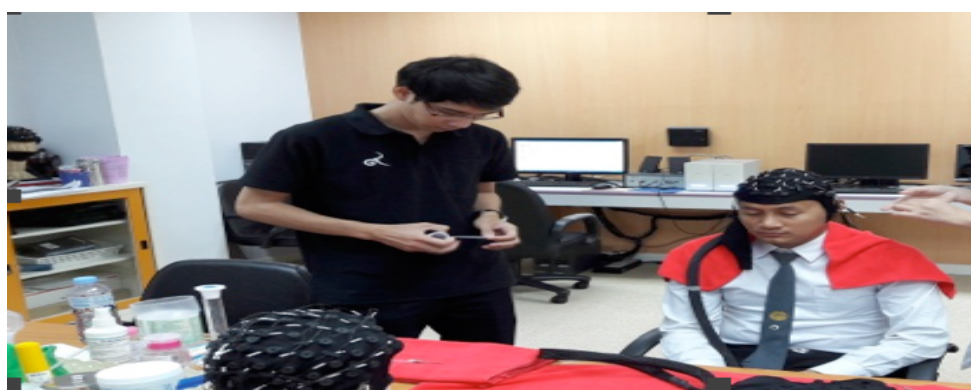
ภาพที่ 3-10 การสวมหมวกที่มีขั้วไฟฟ้า (Electrode) และการบรรจุน้ำเกลือ (Electrolyte) เพื่อนำสัญญาณไฟฟ้า
