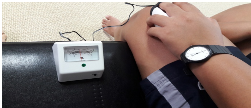
ภาพที่ 3-9 การวัดความเครียดด้วย Galvanic Skin Response II
