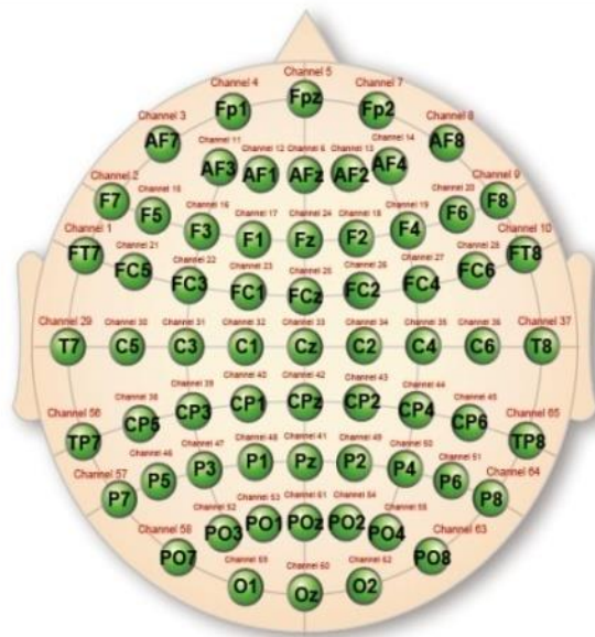
ภาพที่ 3-9 ตำแหน่งอิเล็กโทรดที่ใช้บันทึกคลื่นไฟฟ้าสมอง 64 ช่องสัญญาณ
