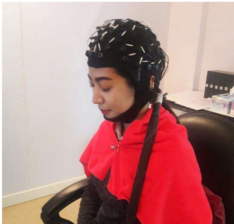
ฉ-3 หมวกอิเล็กทรอนิกส์ที่อ้างอิงระบบมาตรฐานสากล 10-20 มี 64 ช่องสัญญาณ
