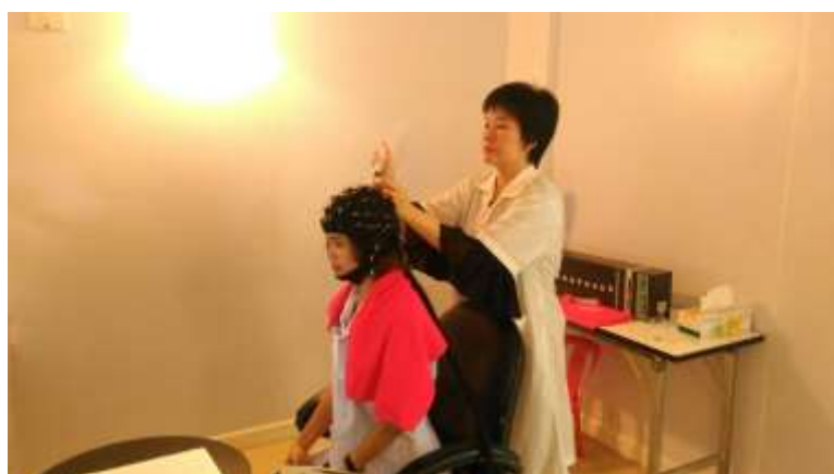
ภาพที่ 3-10 การสวมหมวกที่มีขั้วไฟฟ้า (Electrode) และการบรรจุน้ำเกลือ (Electrolyte) เพื่อนำสัญญาณไฟฟ้า
