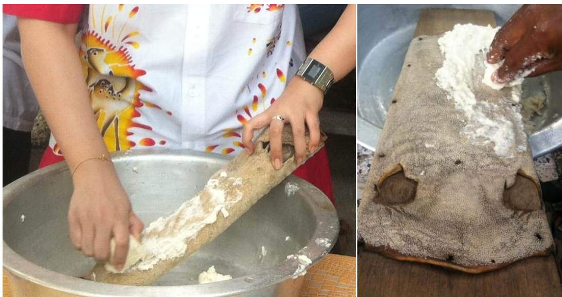
ภาพที่ 11 การฝนหัวเท้าขาม้อมโดยใช้หนังปลากระเบนแห้งพันแผ่นไม้
