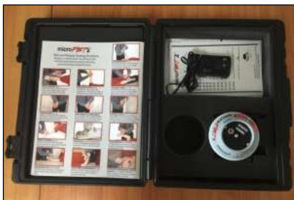
ภาพที่ 2-5 เครื่องวัดขนาดหน้าท้องมือ Micro Fet2
