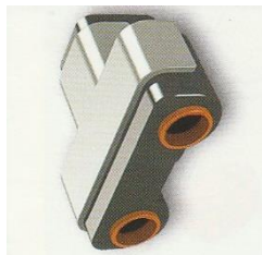
ภาพที่ 77 เซนเซอร์วัดระยะ (Ultrasonic sensor)
