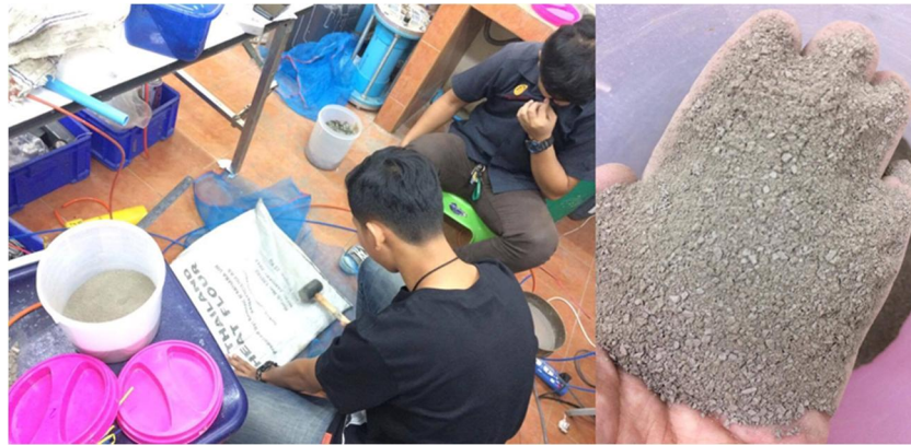
ภาพที่ 4-4 ทูบดินแห้งเพื่อลดขนาดของเม็ดดินด้วยก้อนยางจนสามารถร่อนผ่านตะแกรงเบอร์ 40
