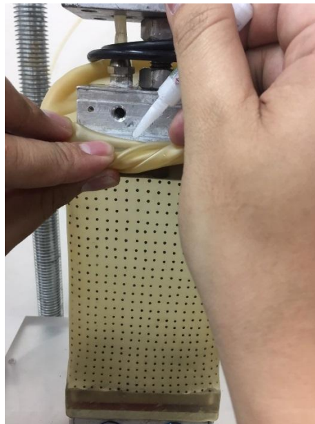
ภาพที่ 4-18 ติดถุงยางเข้ากับแท่นกดด้านบน
