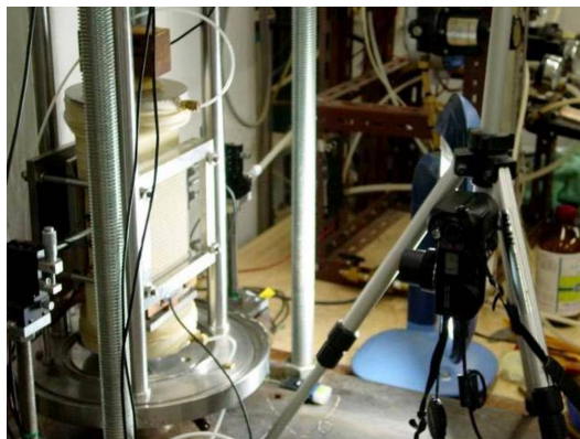
ภาพที่ 2-19 ตัวอย่างดินและอุปกรณ์ทั้งหมดพร้อมทำการทดสอบ (Kongkitkul, 2004)
