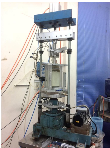
ภาพที่ 4-36 เครื่องทดสอบแรงเฉือนในสภาวะแวดล้อมความเครียดในระนาบ
