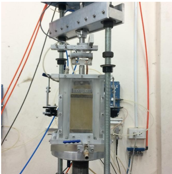
ภาพที่ 4-25 การใช้น้ำกำจัดฟองอากาศในระบบและเซลล์ทดสอบ
