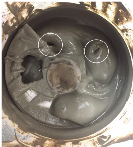
ภาพที่ 4-10 ฟองอากาศที่ระเบิดออกมาจากดินเหลว
