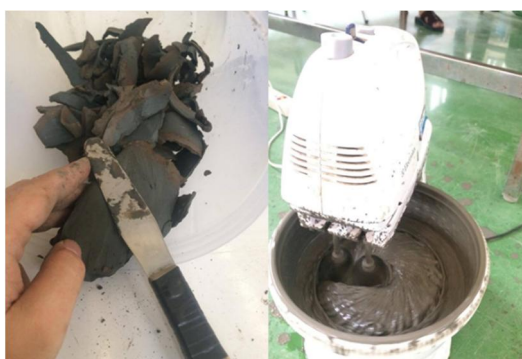
ภาพที่ 4-1 การย่อยดินและปั้นดินให้เข้ากันน้ำ
