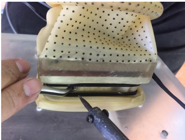
ภาพที่ 4-15 ใช้หัวแร้งเจาะถ่วงยางเพื่อให้เป็นรูยึดสกรู
