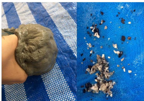
ภาพที่ 4-2 การกรองเศษหินและเปลือกหอยออกจากดินเหนียวเหลว
