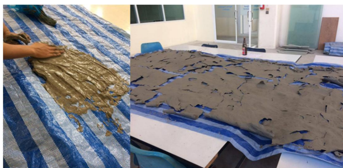
ภาพที่ 4-3 การปาดดินและตากดินในที่ร่มเพื่อลดปริมาณความชื้นในดิน
