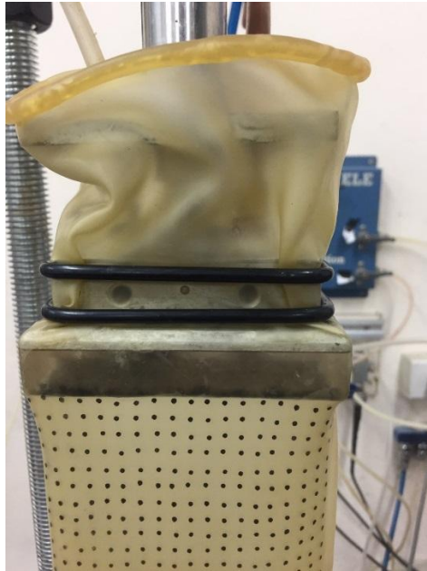
ภาพที่ 4-19 ติดตั้งโอริงเข้ากับแท่นกดด้านบน
