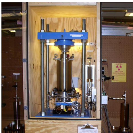
ภาพที่ 2-12 เครื่องมือทดสอบแรงอัดสามแกนแบบแรงดันสูง (Casey, 2014)
