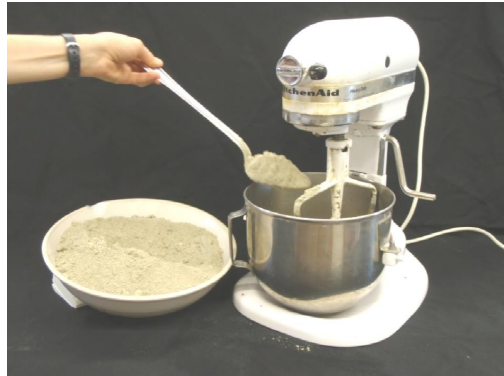
ภาพที่ 2-13 ดินที่บดละเอียดแล้วมาผสมเข้ากับน้ำ (Casey, 2014)
