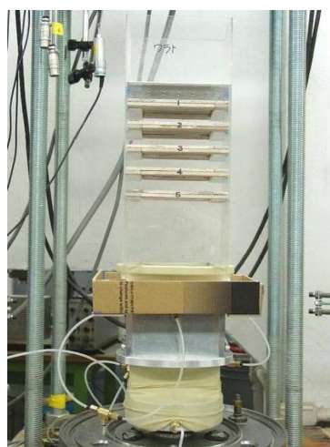
ภาพที่ 2-17 ประกอบโมลเข้ากับอุปกรณ์และให้แรงดันลบกับผิวสัมผัสระหว่างโมลกับถุงยาง (Kongkitkul, 2004)
