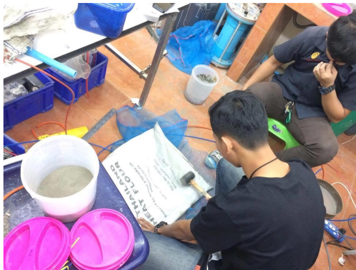
ภาพที่ 3-5 ทบดินแห้งเพื่อลดขนาดของเม็ดดินด้วยก้อนยาง
