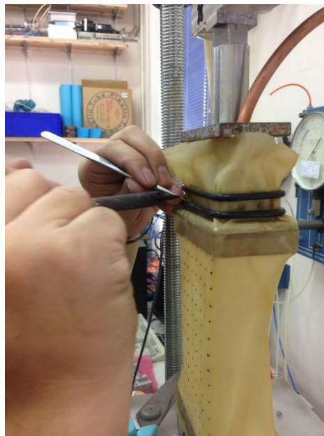
ภาพที่ 4-20 ใช้หัวแรงเจาะตุ้งยางเพื่อให้เป็นรูยึดสกรู
