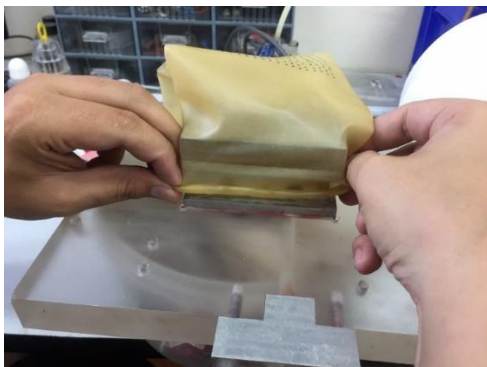
ภาพที่ 4-12 สวมถุงยางเข้ากับแท่นกดด้านล่าง
