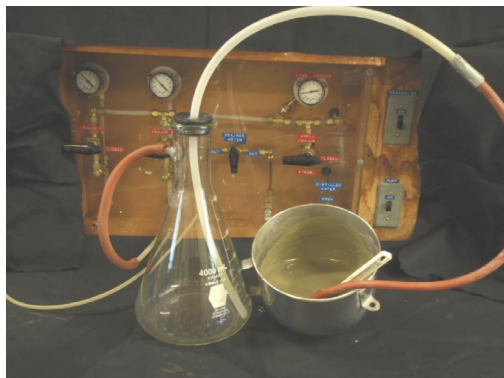
ภาพที่ 2-14 ให้แรงดันลบกับตัวอย่างดินเพื่อสลายฟองอากาศ (Casey, 2014)
