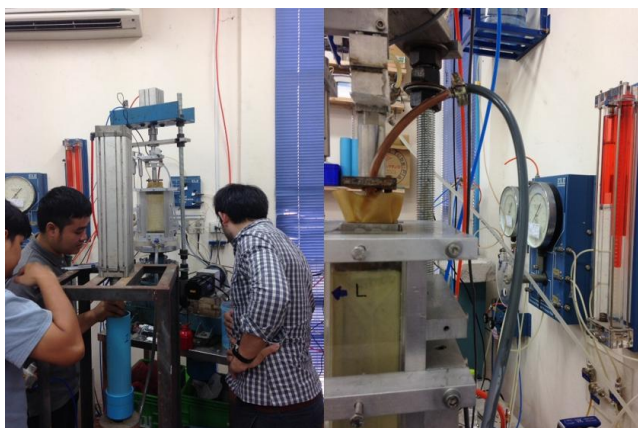
ภาพที่ 4-32 ดันดินเข้าสู่เครื่องทดสอบจนมีดินและน้ำส่วนเกินออกมา
