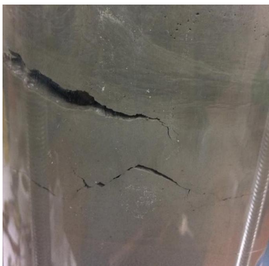
ภาพที่ 4-74 ตัวอย่างดินที่มีรอยแยกเนื่องจากฟองอากาศ
