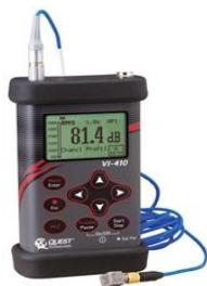
ภาพที่ 3-1 เครื่องวัดความเร่งความสั่นสะเทือนที่บริเวณมือและแขน
