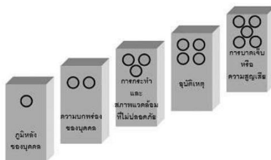
ภาพที่ 2-1 ลักษณะการเกิดอุบัติเหตุตามหลักทฤษฎีโดมิโน (สุภารัตน์ วิชัยรัมย์, 2552)
