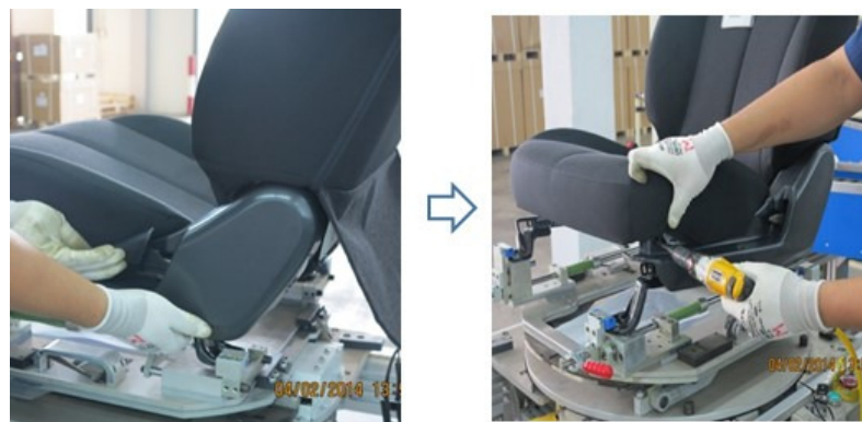
ภาพที่ 4-12 ขั้นตอนการประกอบฝาครอบพลาสติก
