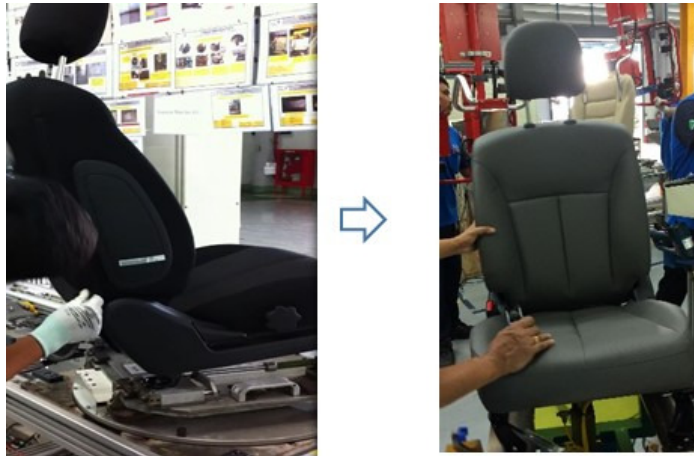
ภาพที่ 4-16 ขั้นตอนการตรวจสอบสภาพความสวยงามของเบาะ
