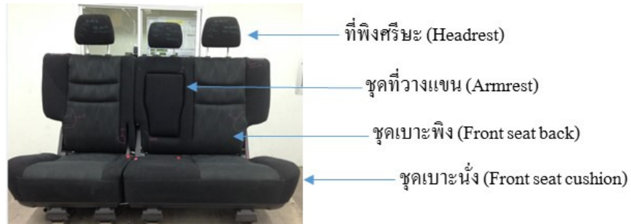
ภาพที่ 4-2 ลักษณะส่วนประกอบต่างๆ ของเบาะแถวสอง
