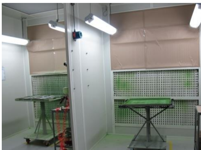
ภาพที่ 3-11 ห้องสำหรับกระบวนการพ่นสี
