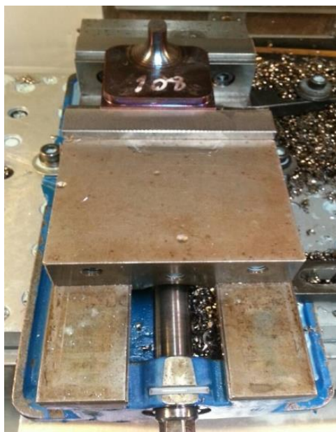
ภาพที่ 4-15 ลักษณะการวางชิ้นงาน Operation 1
