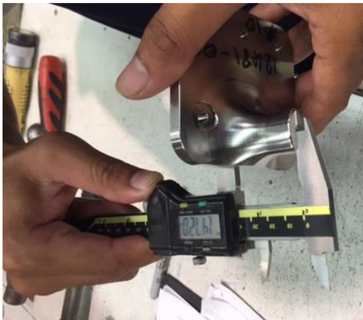
ภาพที่ 3-29 ตำแหน่งการวัด และวิธีวัดขนาดชิ้นงาน
