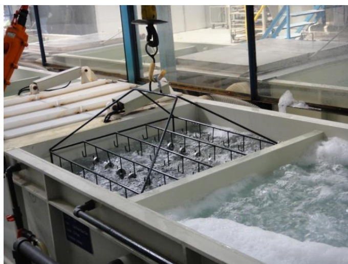
ภาพที่ 3-10 ล้างชิ้นงานด้วยกระบวนการทางเคมี (Etching)
