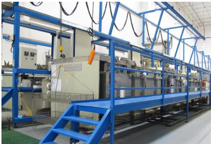
ภาพที่ 3-3 สายการล้างชิ้นงาน และเตรียมผิวชิ้นงาน
