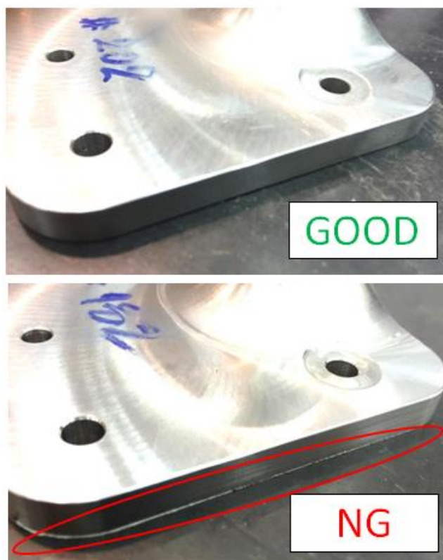
ภาพที่ 4-3 การตรวจสอบครีปหรือคม
