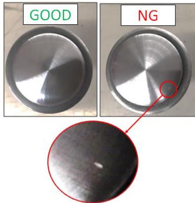
ภาพที่ 4-1 การตรวจสอบรอยบุบ (Dent)
