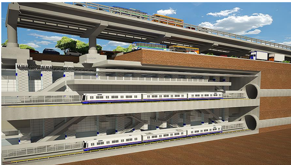
ภาพที่ 4-30 รูปแบบสถานีรถไฟใต้ดินสีลม (สถานีสีลม สถานีที่สร้างยากที่สุด เทคนิคการก่อสร้างขั้นสูงที่เคยเกิดขึ้นในไทย, 2559)
