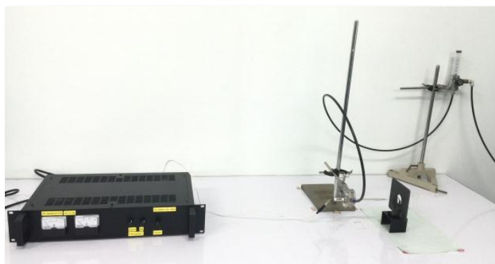
ภาพที่ 3-5 การจัดชุดอุปกรณ์และเครื่องมือสำหรับผลิตพลาสมาเจ็ท
