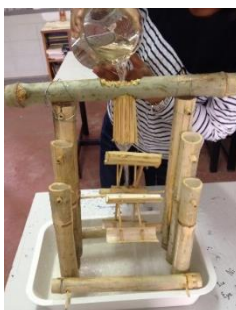
ภาพที่ 4-17 แสดงการสาธิตการทำงานสิ่งประดิษฐ์ กลุ่มที่ 2 กิจกรรมจากงานที่ได้รับมอบหมาย เรื่องสิ่งประดิษฐ์เพิ่ม DO แบบใหม่ไม่ใช่พลาสติก
