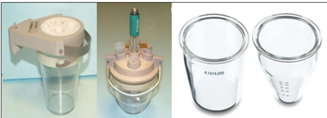
ภาพที่ 2-1 เซลล์บรรจุสารรูปแบบต่างๆสำหรับการวิเคราะห์ทางเคมีไฟฟ้า (Metrohm Autolab B.V. n.d.; Used-Line Used Hi-Tech & Scientific Equipment, n.d.)
