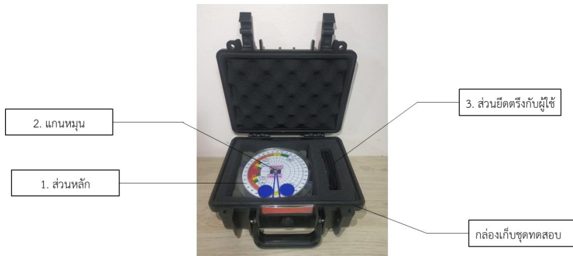
รูปที่ 16 ส่วนประกอบของ BUU ROM test kit: Self-Assess Goniometry
