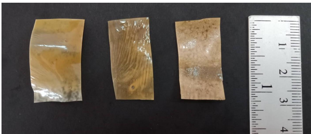
ภาพที่ 4-3 ลักษณะของแผ่นเจลาตินที่มีปริมาณความชื้นแตกต่างกัน (A) แผ่นเจลาตินที่มีปริมาณความชื้น 13% (B) แผ่นเจลาตินที่มีปริมาณความชื้น 18% (C) แผ่นเจลาตินที่มีปริมาณความชื้น 23%
