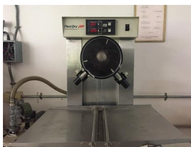
เครื่อง freeze dryer (ยี่ห้อ Flexi-dry™ \mu D รุ่น FGS) (A)
