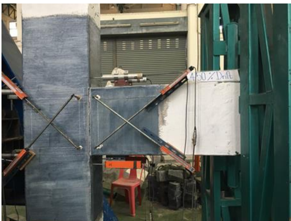
ความเสียหายตัวอย่าง J7R เมื่อแผ่นไฟเบอร์เริ่มฉีกขาด
