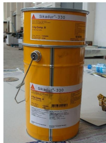
รูปที่ 2.6 แผ่นไฟเบอร์เสริมกำลัง SikaWrap 430G และวัสดุเชื่อมประสาน Sikadur 330
