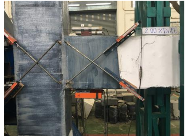
ความเสียหายตัวอย่าง J9R ที่จุดรับกำลังสูงสุด
