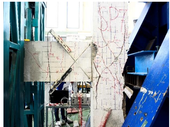
ความเสียหายตัวอย่าง J7 ที่เกิดการวิบัติ
