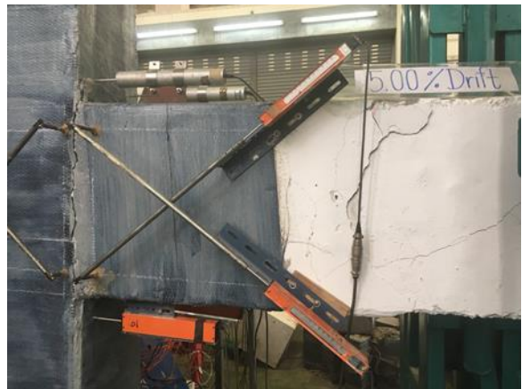
ความเสียหายตัวอย่าง J9R เมื่อแผ่นไฟเบอร์ฉีกขาดสมบูรณ์
