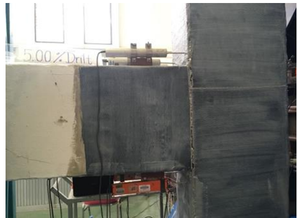
ความเสียหายตัวอย่าง J7R เมื่อแผ่นไฟเบอร์ฉีกขาดสมบูรณ์
