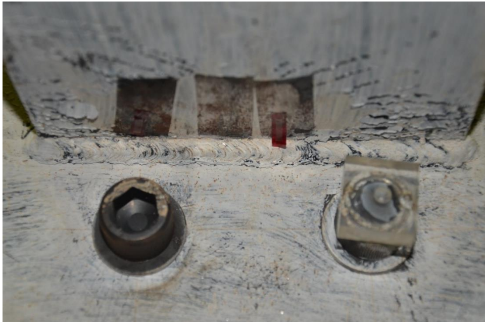
รูปที่ 4.8 การครากที่บริเวณแผ่นปิกด้านล่างของคาน SP1
