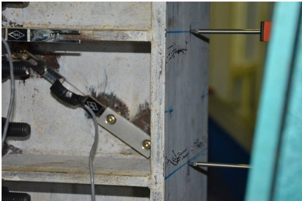
รูปที่ 4.9 แสดงการครากที่บริเวณด้านหลังของแผ่นปีกเสา SP1
