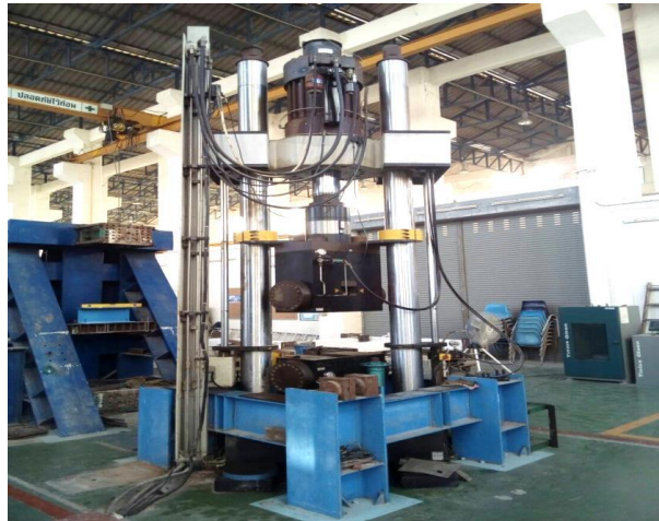
รูปที่ 3.8 เครื่องทดสอบ Universal Testing Machine (UTM)
