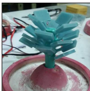
รูปที่ 3.1 การเตรียมชิ้นงาน 1.) ชิ้นงานที่ 2.) ต้นเทียน และ 3.) นำกระบอกล่อปูนครอบฐานยาง
