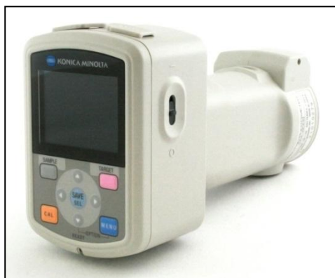
รูปที่ 3.10 เครื่องวัดสี Konica Minolta 700d
