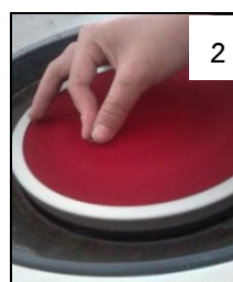
รูปที่ 3.6 ขัดชิ้นงาน 1) ขัดกระดาษทราย และ 2) ขัดผ้าสักหลาด
