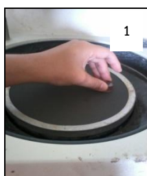
รูปที่ 3.6 ขัดชิ้นงาน 1) ขัดกระดาษทราย และ 2) ขัดผ้าสักหลาด
