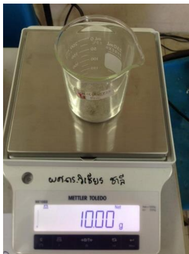
ก) นำตัวอย่างที่ผ่านตะแกรงเบอร์ 20 มาชั่งน้ำหนัก
