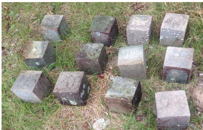
รูปที่ 4.4 สภาพผิวคอนกรีตที่ผสมเถ้าถ่านหินที่แช่น้ำทะเลเป็นเวลา 5 ปี
