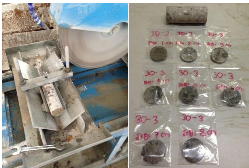
รูปที่ 3.5 การตัดตัวอย่างคอนกรีตที่ได้จากการเจาะ
