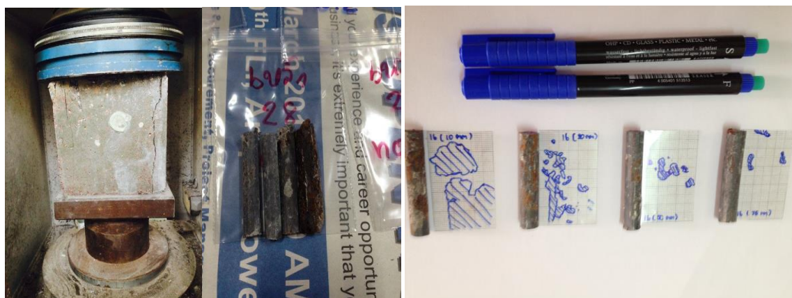
รูปที่ 3.9 การวัดการเกิดสนิมในเหล็กที่ฝังในคอนกรีต
