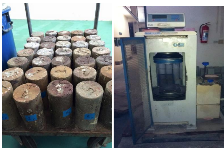
รูปที่ 3.10 ตัวอย่างที่ใช้ในการทดสอบกำลังอัดคอนกรีตหลังแช่น้ำทะเล
