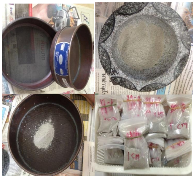
รูปที่ 3.6 การบดตัวอย่างเพื่อทดสอบคลอไรด์
