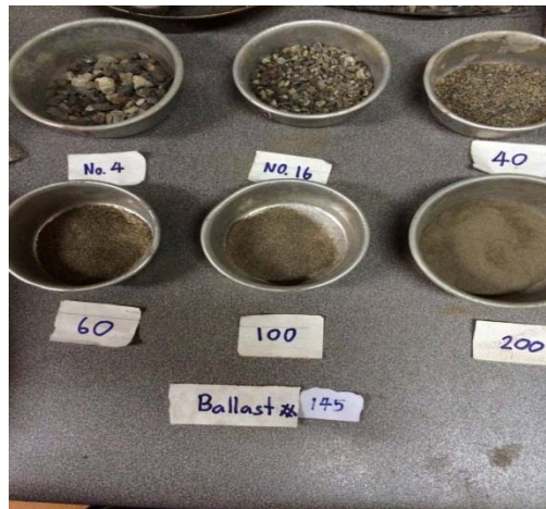
รูปที่ 5-2 Visual inspection ของ Ballast Station 145
