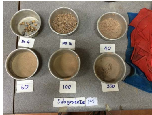
รูปที่ 5-4 Visual inspection ของ Subgrade 1 Station 145
