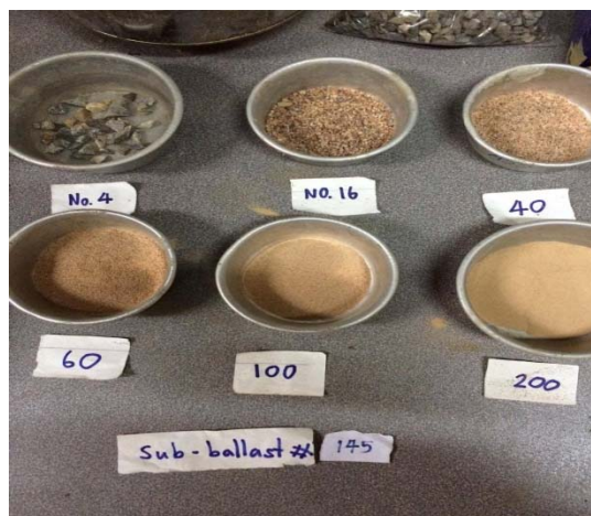
รูปที่ 5-3 Visual inspection ของ Sub-ballast Station 145
