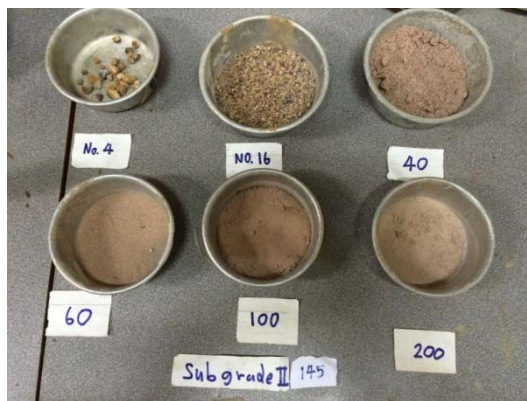
รูปที่ 5-5 Visual inspection ของ Subgrade 2 Station 145
