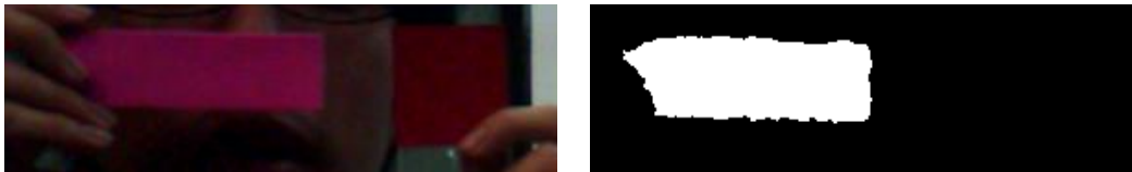
ภาพที่ 4-19 กระบวนการ segmentation เพื่อหาวัตถุด้านซ้าย [4]
