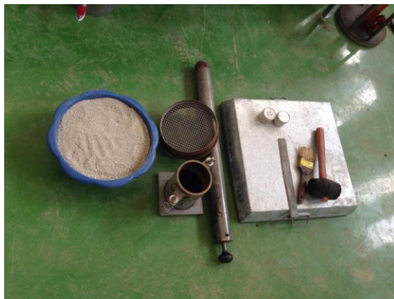
รูปที่ 3.3 อุปกรณ์ที่ใช้ในการทดสอบการบดอัดแบบสูงกว่ามาตรฐาน
