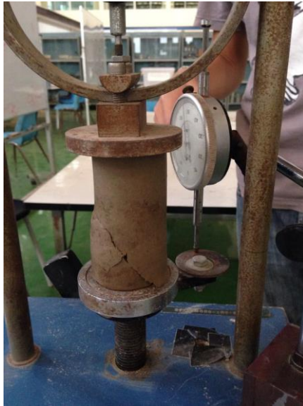
รูปที่ 3.5 ตัวอย่างการทดสอบหาค่ากำลังรับแรงอัดแกนเดียว
