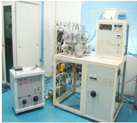
ภาพที่ 1 ลักษณะเครื่องเคลือบและไดอะแกรมของเครื่องเคลือบสุญญากาศที่ใช้ในงานวิจัยนี้
