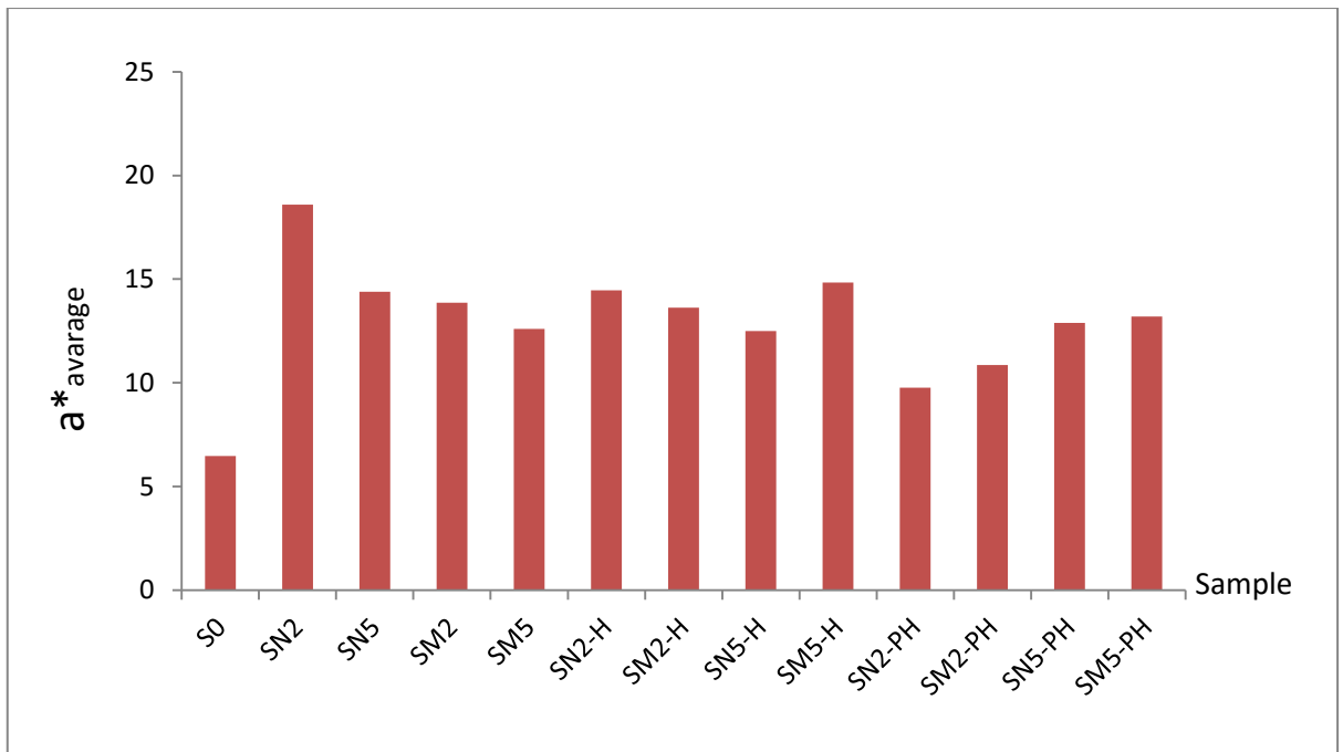
รูปที่ 3.22 กราฟแสดงความสัมพันธ์ระหว่างค่า a^* ของตัวอย่างแผ่นเงินก่อนและหลังการเคลือบด้วยสภาวะต่างกัน
