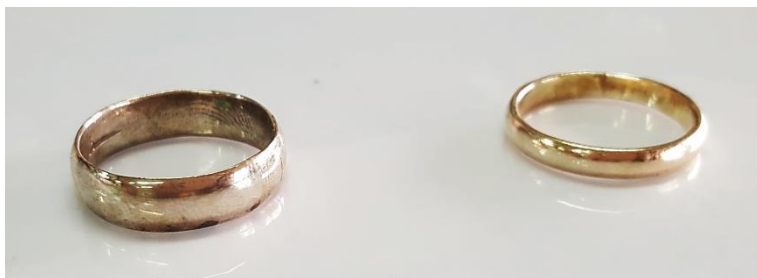
ข. ซ้าย: แหวนเงินไม่เคลือบหลังทดสอบกันหมอง และ ขวา: แหวนเงินเคลือบหลังทดสอบกันหมอง
