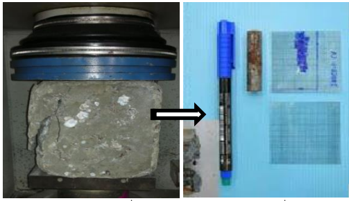
ข) การเตรียมตัวอย่างเพื่อทดสอบการกัดกร่อนเหล็กที่ฝังในคอนกรีต
