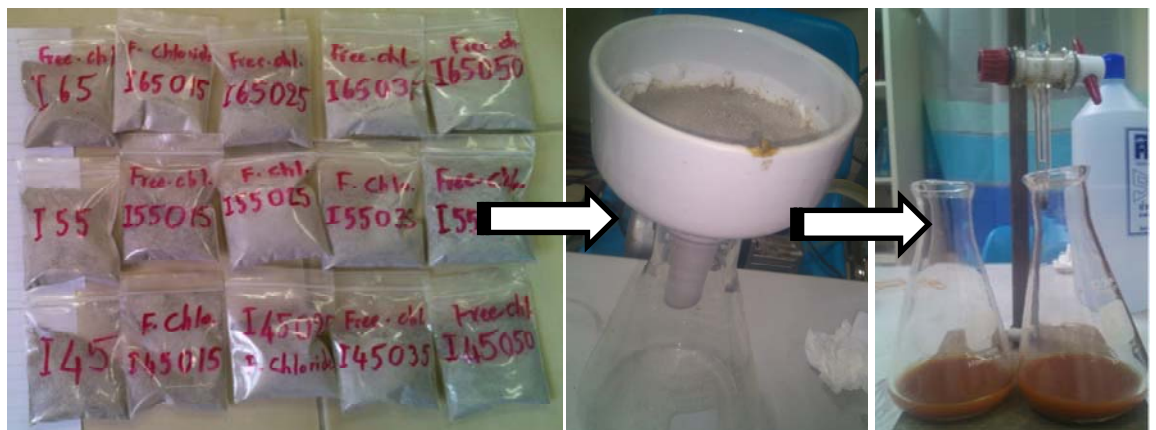
รูปที่ 3.5 ตัวอย่างคอนกรีตสำหรับทดสอบปริมาณคลอไรด์ในคอนกรีต
