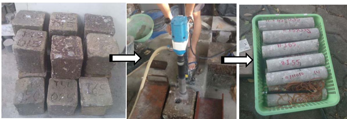
รูปที่ 3.3 การเจาะตัวอย่างคอนกรีตเพื่อทดสอบการแทรกซึมของคลอไรด์
