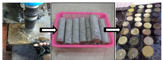
ก) การเตรียมตัวอย่างเพื่อทดสอบกำลังอัดของคอนกรีต
