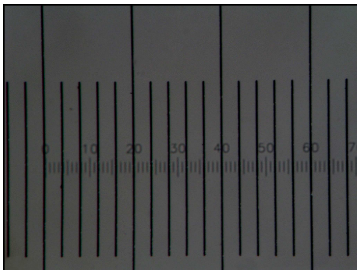
ภาพภาคผนวก ข-1 การปรับเทียบสเกลของ Ocular Micrometer และ Stage Micrometer ที่กำลังขยาย 400 เท่า
