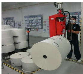
ภาพที่ 5 พนักงานใช้เครื่องช่วยยกยกม้วนฟิล์มเข้าสู่กระบวนการผลิต
