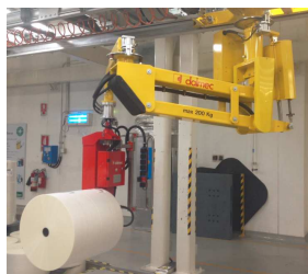
ภาพที่ 5 พนักงานใช้เครื่องช่วยยกยกม้วนฟิล์มเข้าสู่กระบวนการผลิต
