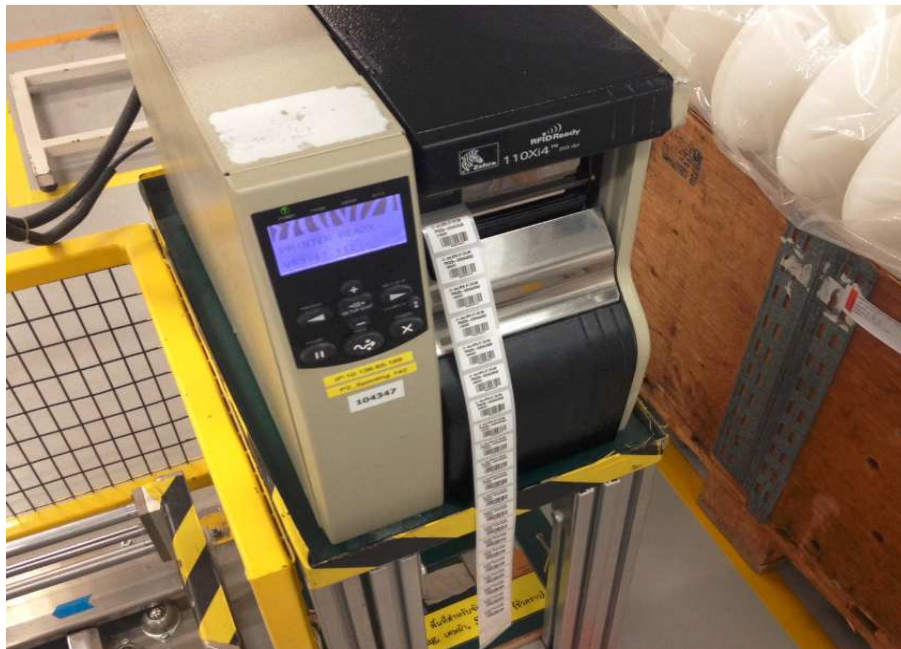
ภาพที่ 29 ปรับปรุงโปรแกรมให้พิมพ์ป้ายแสดงหมายเลขโดยอัตโนมัติ
