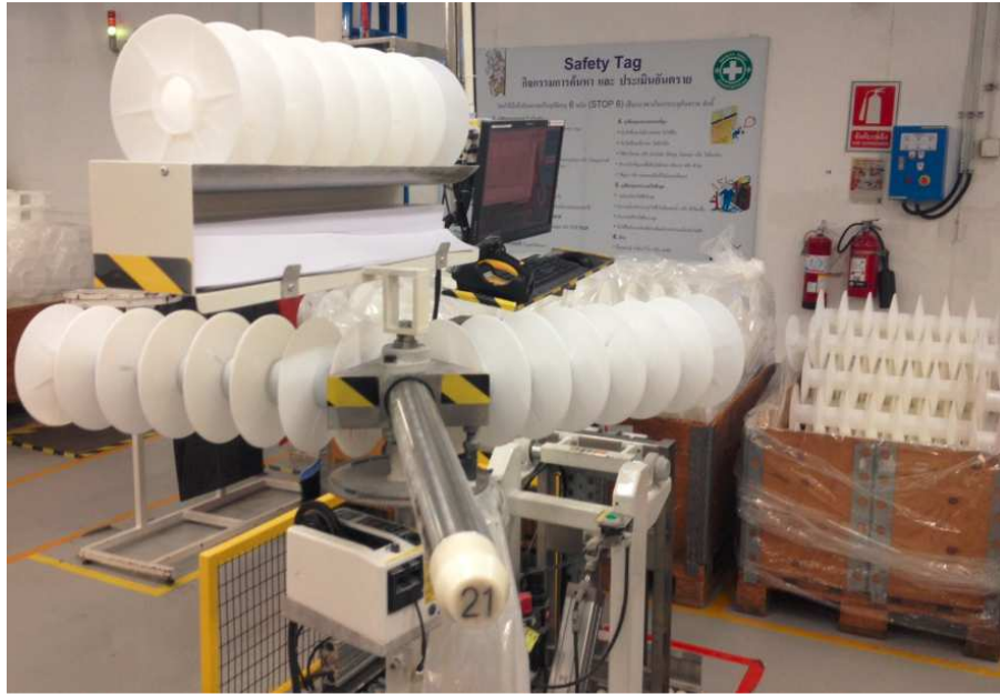
ภาพที่ 28 เตรียมแกนพลาสติกที่เครื่องจักรเพื่อลดเวลาการปฏิบัติงาน
