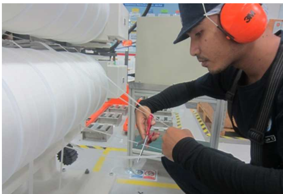
ภาพที่ 25 พนักงานใช้กรรไกรตัดเพื่อเปลี่ยนม้วนงาน
