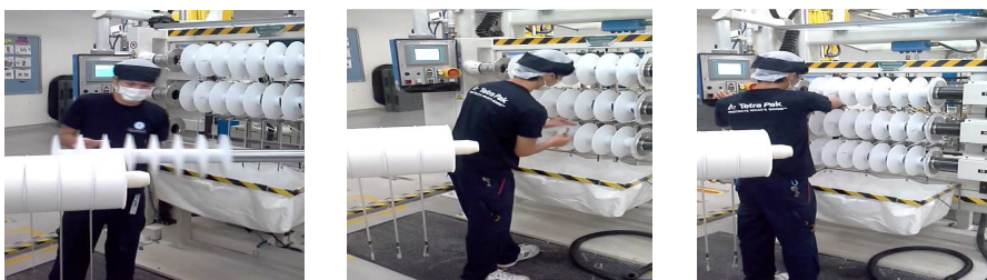
ภาพที่ 10 พนักงานใส่แกนพลาสติกใหม่เข้าท้ายเครื่องจักร
