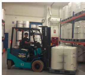
ภาพที่ 2 พนักงานคลังสินค้าเคลื่อนย้ายพาเลทม้วนฟิล์มจากคลังสินค้าโดยรถยกแบบไฟฟ้า
