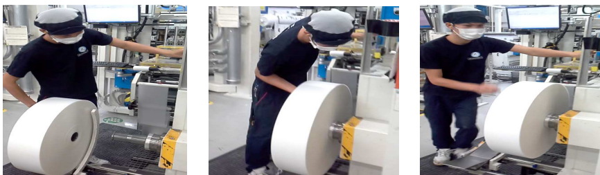
ภาพที่ 6 พนักงานดัดม้วนฟิล์มเข้าเครื่องจักร
