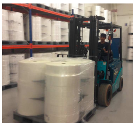
ภาพที่ 2 พนักงานคลังสินค้าเคลื่อนย้ายพาเลทม้วนฟิล์มจากคลังสินค้าโดยรถยกแบบไฟฟ้า
