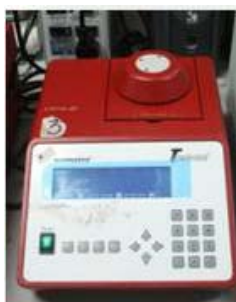
ภาพที่ 15 เครื่อง Thermocycler (ภาพโดย กิตติชัย สุพรรณพันธุ์)
