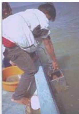
ภาพที่ 21 การเก็บตัวอย่างโดยใช้เครื่องมือ Grab sampler (ภาพโดย กิตติรัช สุพรรณพันธุ์)
